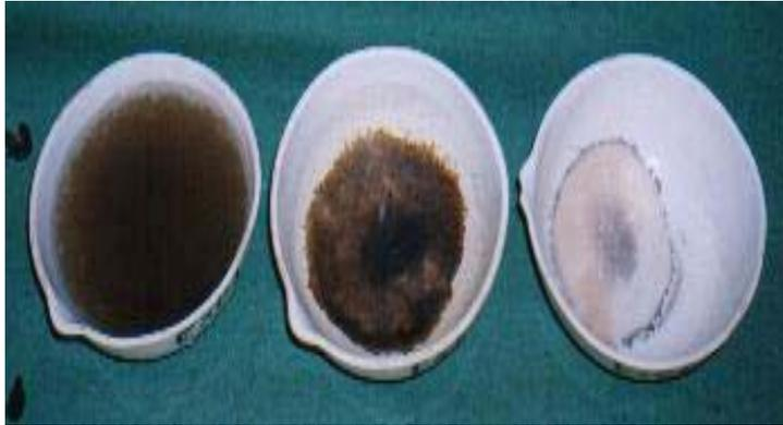
**Figura 3.9** – Lodo aeróbio do decantador secundário da ETE Cabo, na forma fluida (à esquerda), seco a 105°C (ao centro) e calcinado a 550°C (à direita).
