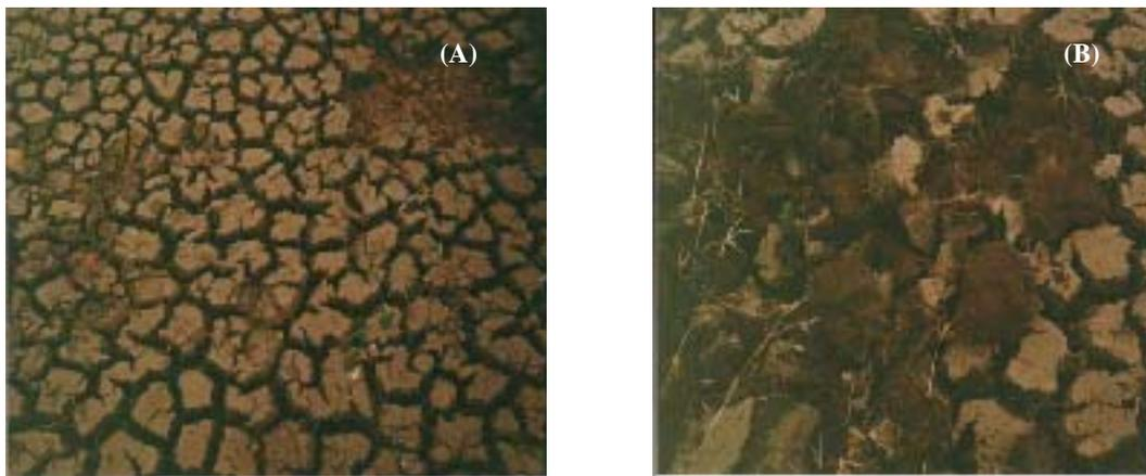
**Figura 5.5** – Vista das fissuras na camada superficial da massa de lodo seco no leito de secagem da ETE Mangueira (A) e perfil do lodo seco no leito de secagem da ETE Mangueira (B).
