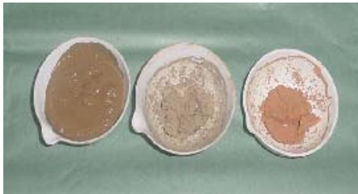
**Figura 3.8** – Lodo do decantador da ETA Gurjaú, na forma semi-sólida (à esquerda), seco a 105°C (ao centro) e calcinado a 550°C (à direita).
