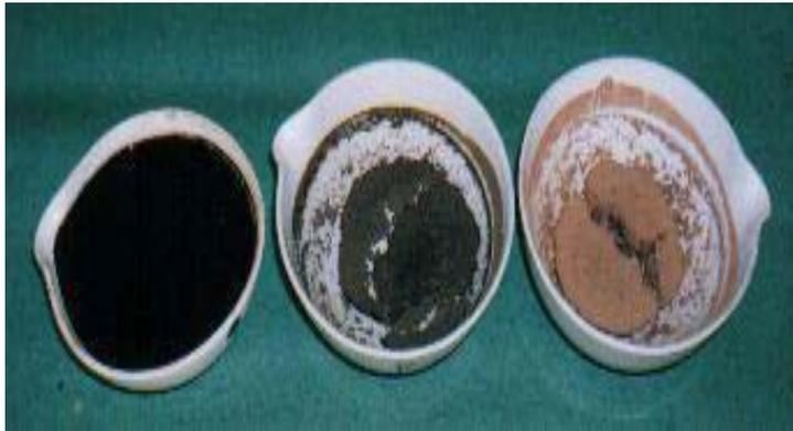
**Figura 3.10** – Lodo anaeróbio do reator UASB da ETE Mangueira, na forma fluida (à esquerda), seco a 105°C (ao centro) e calcinado a 550°C (à direita).
