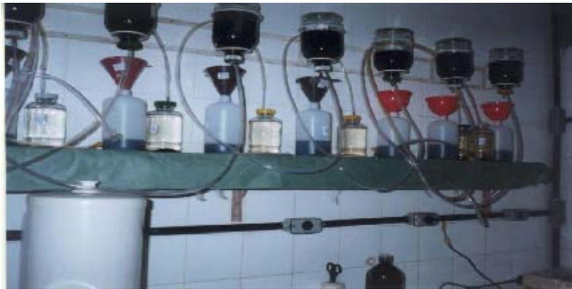
**Figura 6.2** – Esquema do conjunto experimental do teste de AME.
