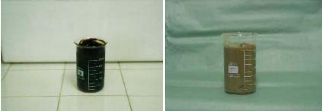
**Figura 3.2** – Aspecto do lodo do decantador da ETA Presidente Castello Branco (à esquerda) e ETA Gurjaú (à direita) (sulfato de alumínio como coagulante)
