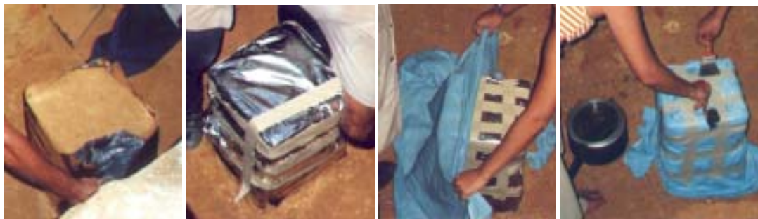
Foto III.2 – Acondicionamento das amostras indeformadas.
