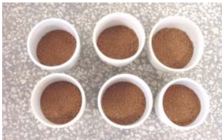
Foto III.6 – Utilização de cápsulas de porcelana para determinação do teor de matéria orgânica.
