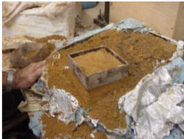
Foto III.12 – Moldagem do corpo de prova do ensaio de cisalhamento direto.
