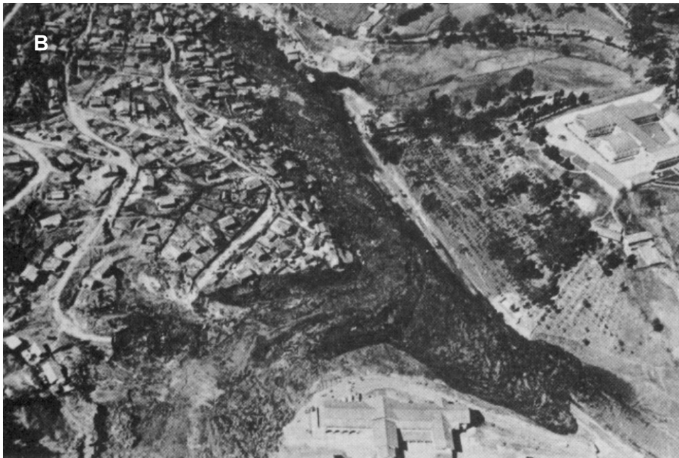
Foto II.2 – (A) Escorregamento em Petrópolis (RJ) (Foto de O. Augusto Filho, 1988) e (B) Corrida em Campos do Jordão (SP).
