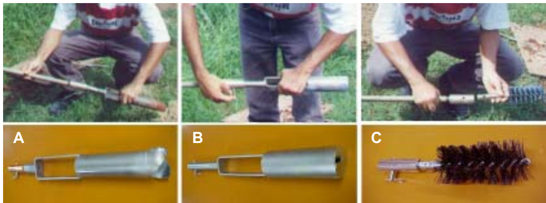
Foto III.3 – Suplementos do trado manual: (A) escavação, (B) limpeza e nivelamento e (C) escova de náilon.
