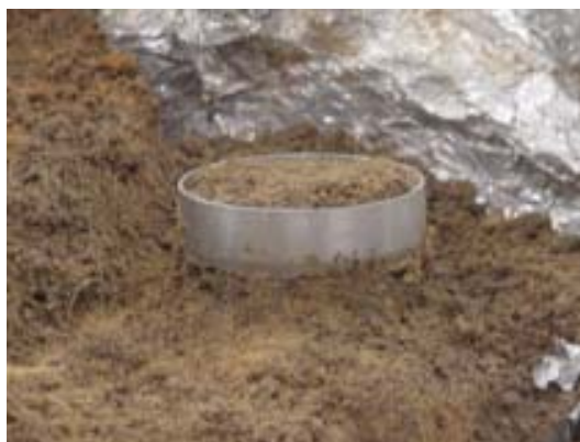
Foto III.10 – Moldagem dos corpos de prova do ensaio edométrico.
