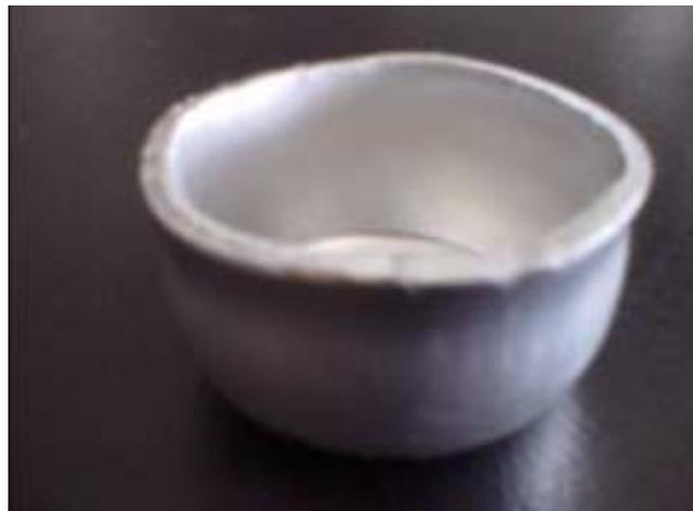
Figura 4.77. Liga Al-0,84Fe-0,63Si parcialmente recristalizada a 325°C (apresentando 95% de fração recristalizada) submetida ao ensaio de embutimento.
