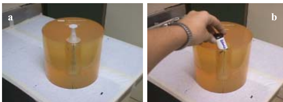
Figura 7. Posicionamento das fontes de ^{131}\text{I} no interior do simulador de pescoço: (a) posicionamento das seringas e (b) posicionamento dos sacos plásticos para posterior aquisição das imagens.
