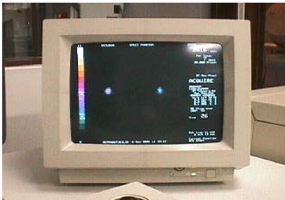
Figura 9. Imagens digitais durante aquisição de uma fonte de ^{131}\text{I} posicionada dentro do simulador de pescoço-tiróide quando da utilização da técnica da tripla janela de energia para a correção de espalhamento e de penetração septal.
