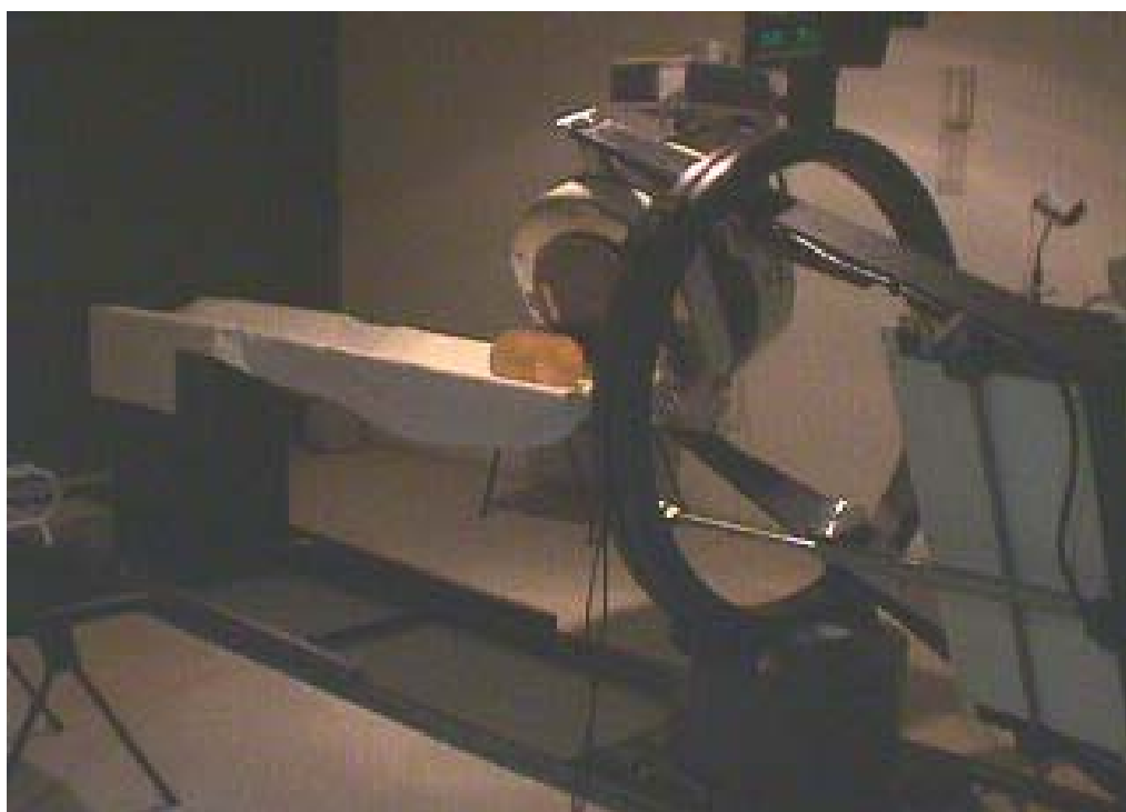
Figura 8. Câmara de Cintilação, modelo STARCAM 2000, fabricada pela GE Medical System, montada com um colimador de furos paralelos para alta energia, adquirindo imagens tomográficas do simulador de pescoço, modelo 3108, fabricado pela Searle Radiographics Ind.
