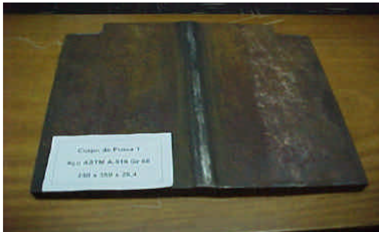
Figura 5.6 – Corpo de prova para qualificação do procedimento de soldagem (500 x 500 x 25 mm)
