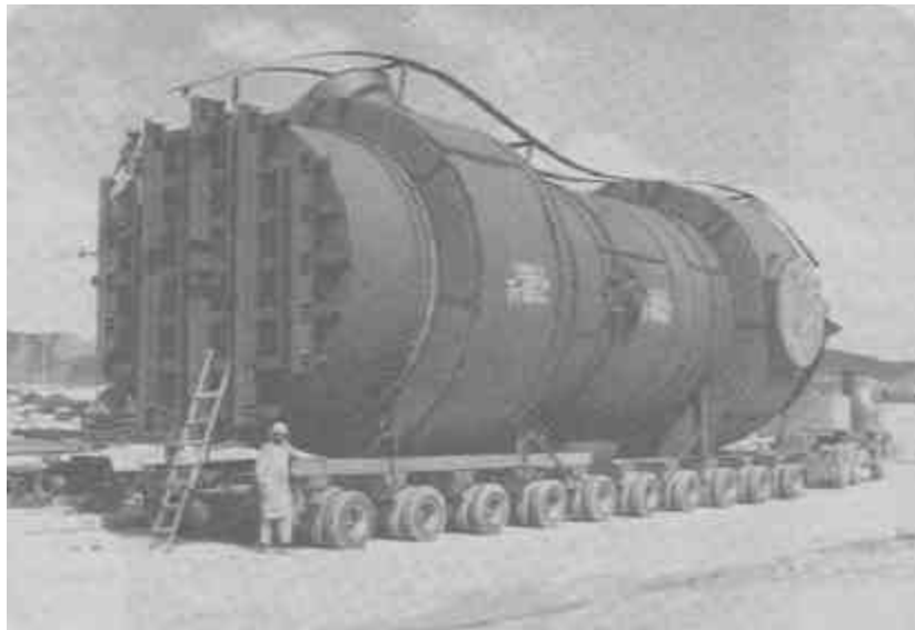
Figura 4.4 - Grande vaso de pressão para ácido sulfúrico, para Caraíbas Metais. Peso: cerca de 200t. (Telles, 1991)
