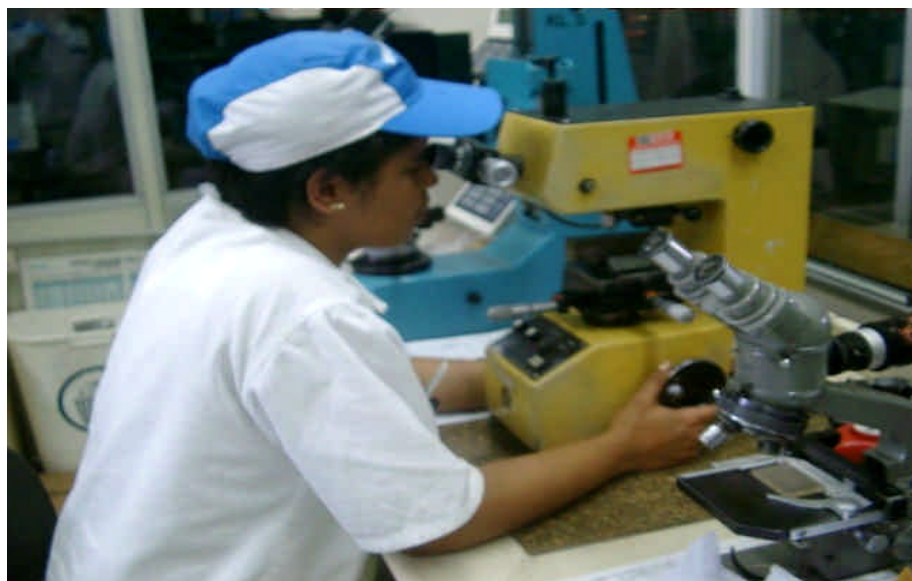
Figura 5.10 – Microdurômetro utilizado nos ensaios de microdurezas HV 300gf. Laboratório de Ensaios da Musashi do Brasil/PE.
