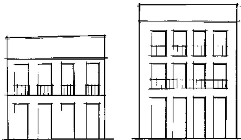
Figura 115: Esquemas (s/ escala) de imóveis sobrados de 02 e três pavimentos característicos do C.H.B.
