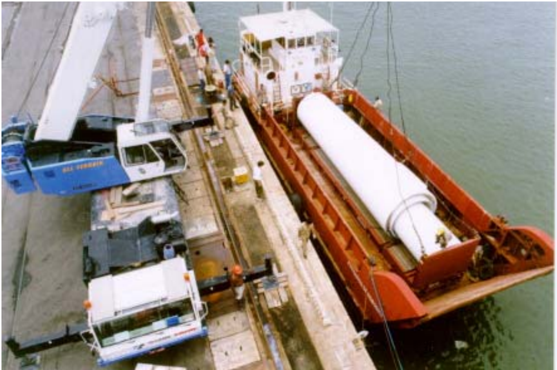
Figura 1 - Embarcação de Desembarque de Veículos Motorizados Fernando de Noronha: 1. Capacidade de 72 toneladas; 2. Comprimento de 15 m.
