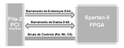
Figura 6.5: Interface paralela entre o Pita-2 e o FPGA
