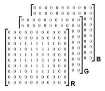
Figura 3.5: Superposição de matrizes formando uma imagem colorida (RGB)
