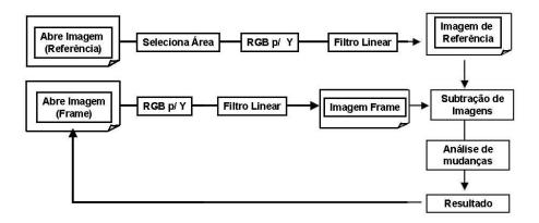
Figura 5.5: Diagrama em blocos do algoritmo de detecção de veículos.
