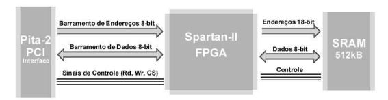
Figura 6.8: Arquitetura da placa: conexão entre a interface, FPGA e memória.
