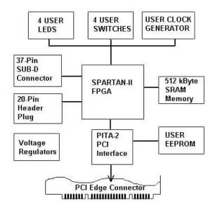
Figura 6.1: Diagrama de blocos da arquitetura da XC2S\_EVAL
