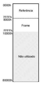
Figura 5.7: Mapeamento de memória utilizado
