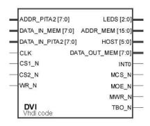
Figura 5.9: Macrocélula do algoritmo detector de veículos em hardware.
