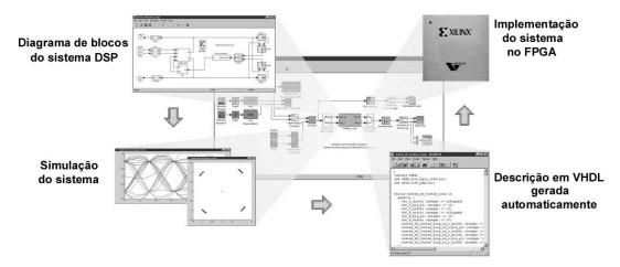
Figura 2.1: Simulação funcional de blocos e geração de código VHDL para Xilinx.
