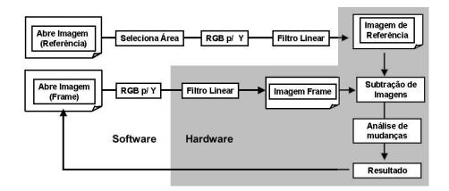
Figura 5.6: Particionamento hardware/software do algortimo de detecção de veículos.
