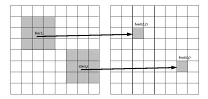
Figura 5.4: Conceito de uma operação baseada em um kernel 3x3.
