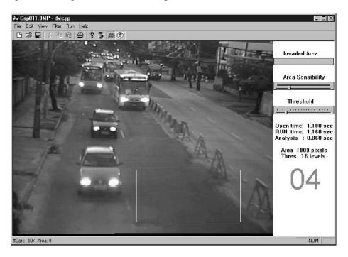
Figura 5.3: Protótipo executável do sistema de detecção de veículos.
