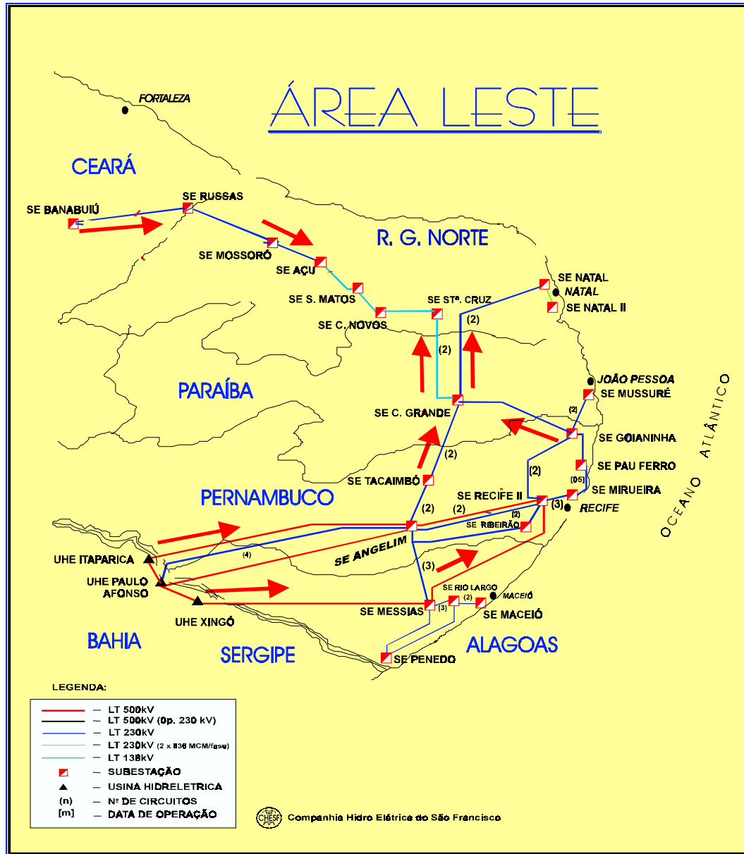
Figura 5.1: Rede de Transmissão Inicial de Mínimo Custo da Área Leste da CHESF
