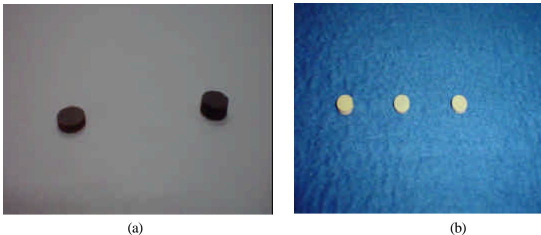
Figura 3.9 - Pastilhas cerâmicas Ba_2HoZrO_{5,5} compactadas e sinterizadas. (a) Ba_2HoZrO_{5,5} 1% e 2% CuO (da esquerda para direita) a uma temperatura de 1250^\circ C durante 48h, (b) Ba_2HoZrO_{5,5} com 0-2% CuO (da esquerda para direita) compactadas e sinterizadas a uma temperatura de 1600^\circ C durante 48h através do processo direto.
