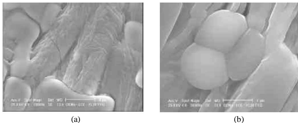
Figura 4.24 – Micrografias obtidas por MEV de superfícies polidas de amostras \text{Ba}_2\text{HoZrO}_{5,5} com 1% de \text{CuO} sinterizadas a 1600^\circ\text{C} por 48h através do processo direto. (a) e (b) elétrons secundários.
