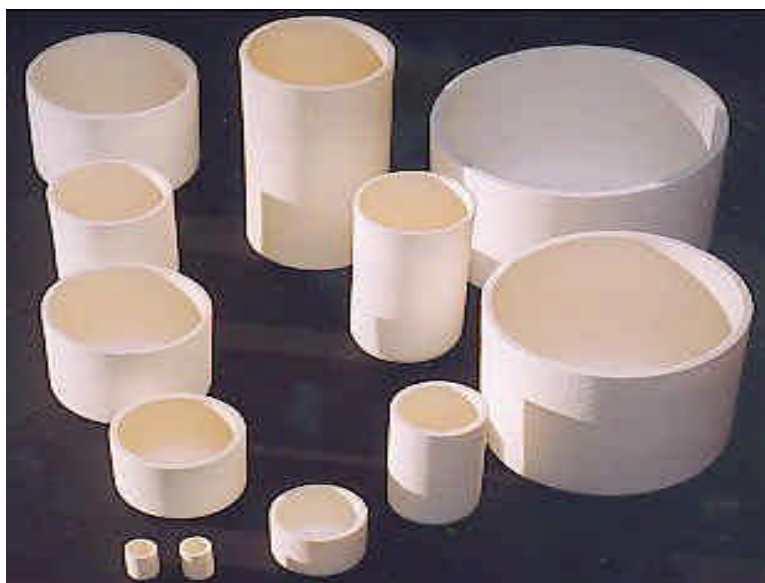
Figura 2.1 - Cadinhos cerâmicos de alumina usados em temperaturas elevadas.
