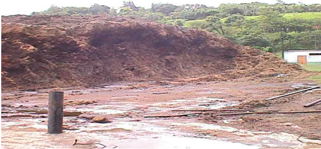
FIGURA 17 – Armazenamento de bagaço sem proteção.
