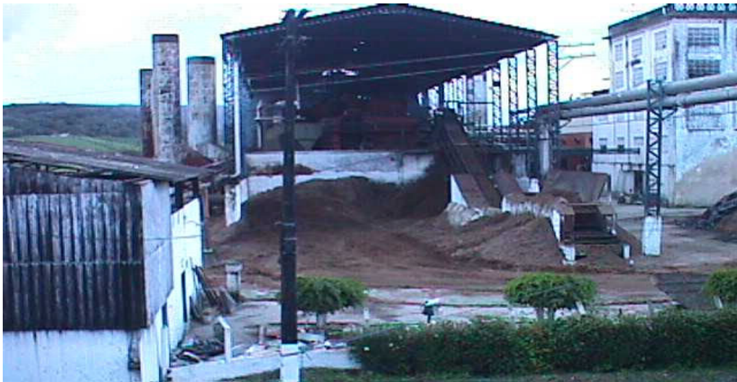
FIGURA 18 – Acumulação inicial do bagaço produzido.
