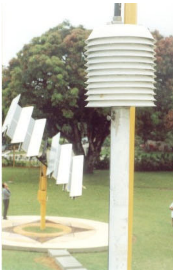
Figura 3.10 Sondar Modelo HMP35C utilizado para medir umidade relativa e temperatura ambiente.
