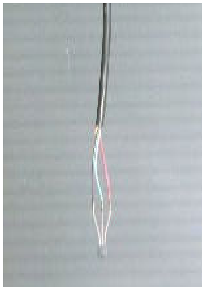
Figura 3.7 Detalhe do sensor LM35 utilizado para a medição da temperatura interna do recinto
