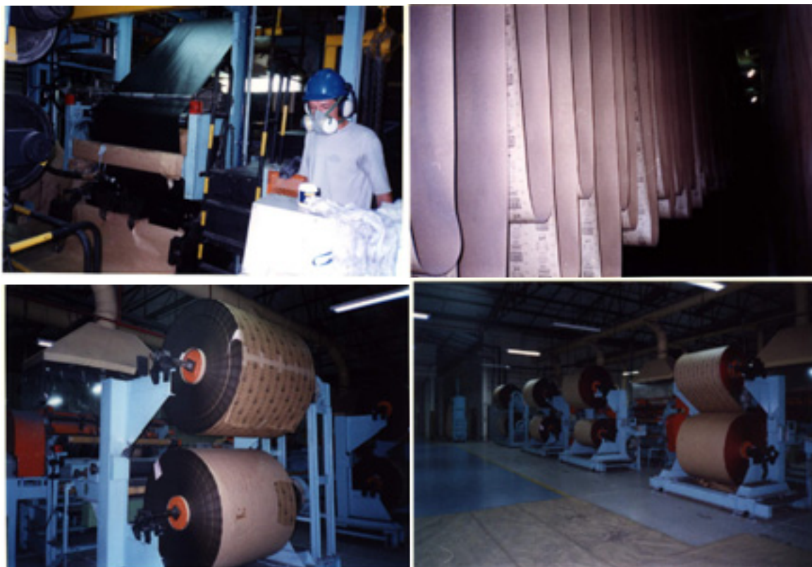
Figura 4.3 – Fluxo de produção de lixas: 1-aplicação do adesivo; 2) cura em estufa; 3) produto acabado (jumbos); 4) linha de corte em folhas.
