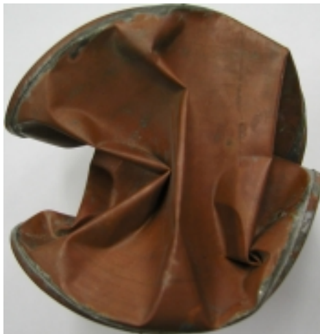
FIGURA 1.1: Estrutura metálica amassada, apresentando ambos, singularidade cônica e vinco.
