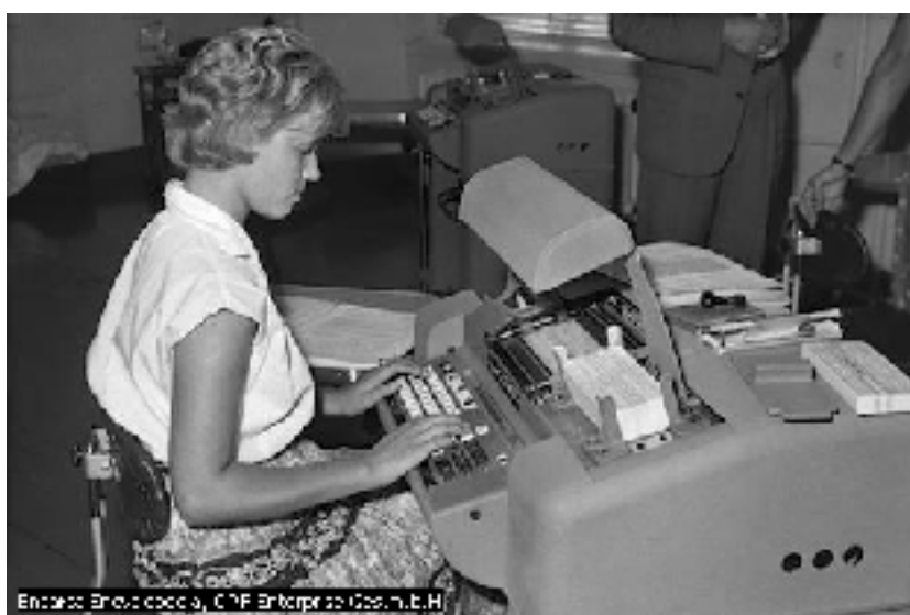
Figura 4.2 – Máquina de perfuração de cartões 1950 (ENCARTA, 2002).
