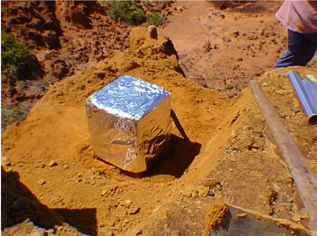
Foto III.9 - Preparação do bloco para parafinação (Formação Barreiras a 0,30m de profundidade).
