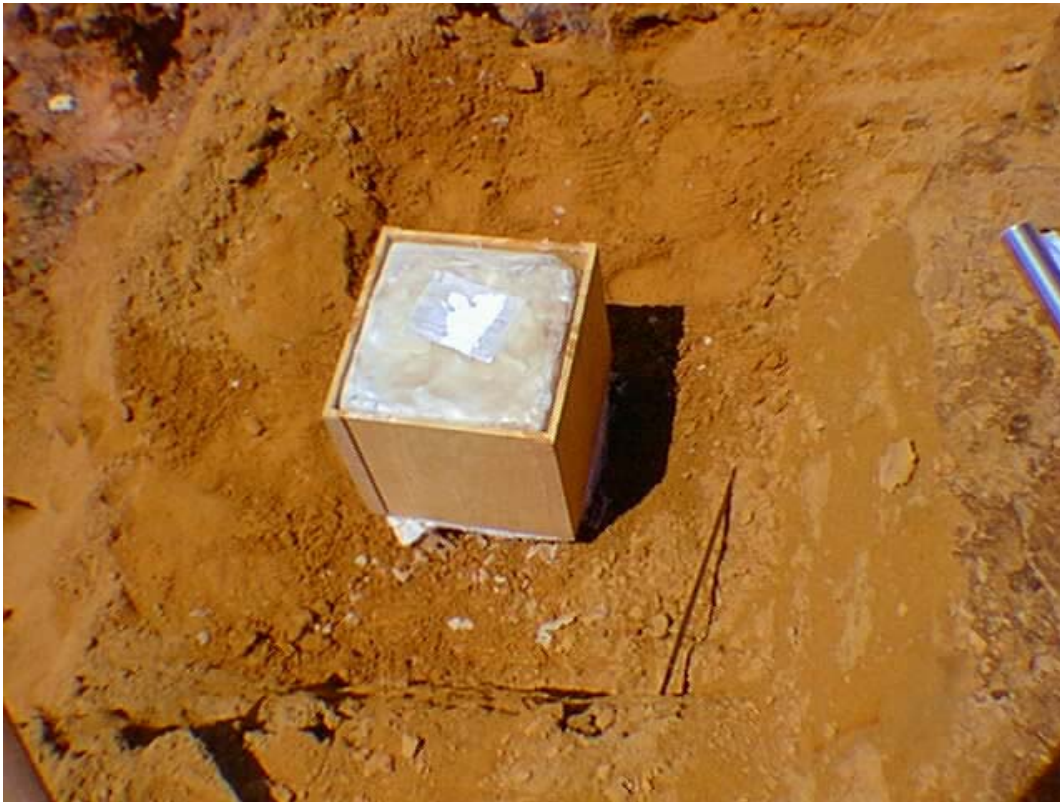
Foto III.11 - Acondicionamento do bloco (Formação Barreiras a 0,30m de profundidade).
