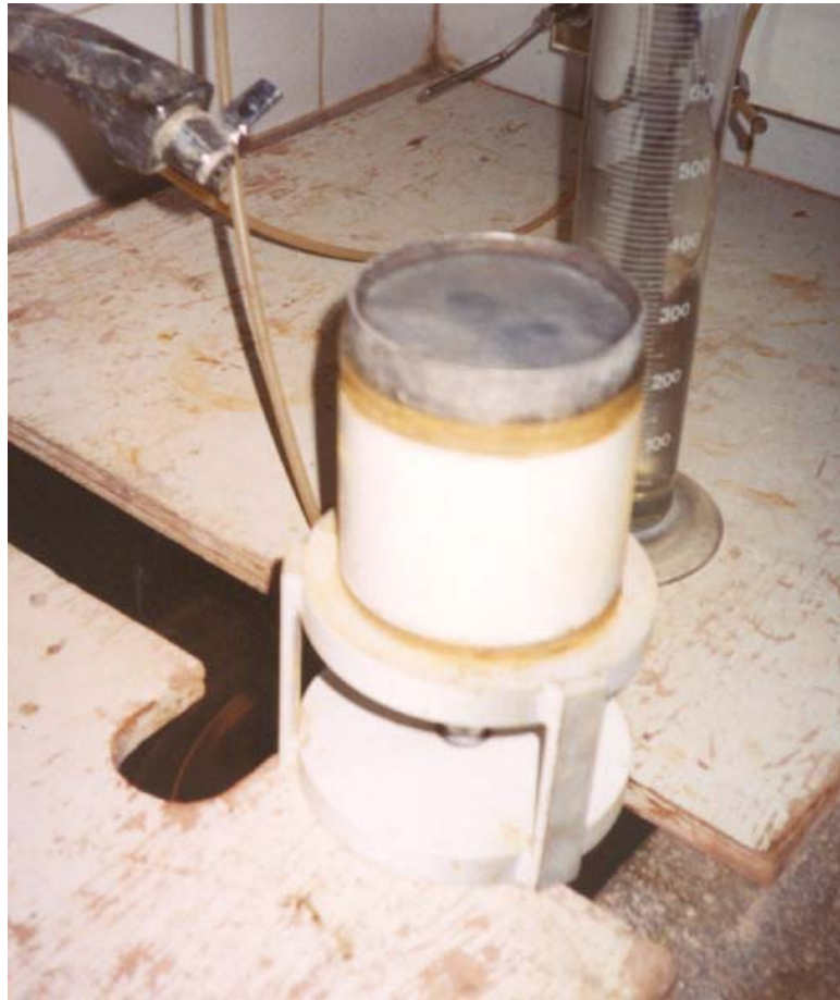
Foto V.6 - Embebecimento por 15 minutos da amostra para chegar ao estágio de saturação.
