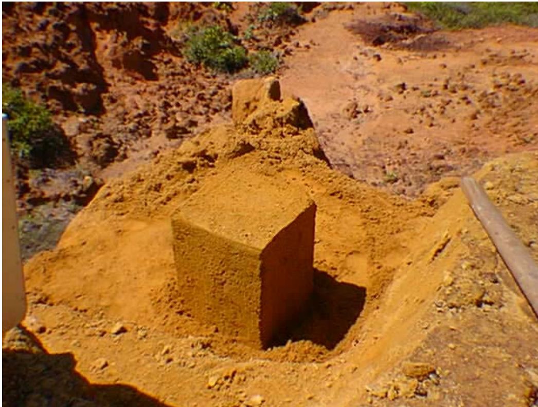
Foto III.8 - Moldagem do bloco (Formação Barreiras a 0,30m de profundidade)
