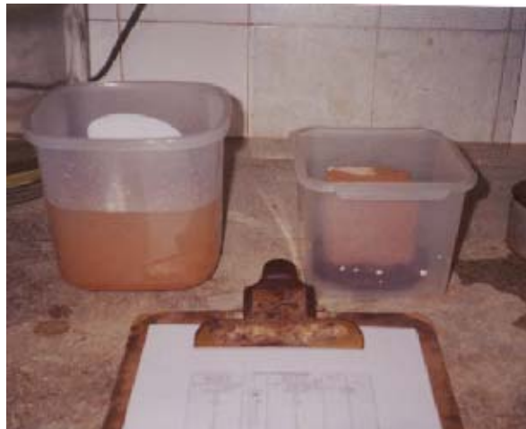
Foto V.2 - Esquema do Ensaio de Desagregação.
