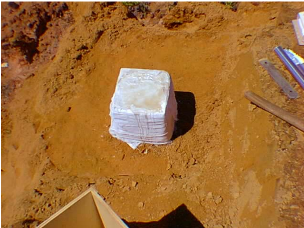
Foto III.10 - Parafinação do bloco (Formação Barreiras a 0,30m de profundidade).
