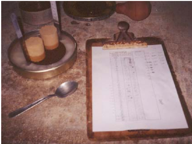
Foto V.7 - Esquema do Ensaio de Infiltração.
