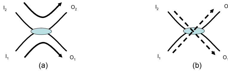
Figura 4.10: Esquema de funcionamento do WDM. (a) acoplamento direto: sinal vai da porta I_1 à porta O_1 ou de I_2 à O_2 , (b) acoplamento cruzado: sinal vai de I_1 à O_2 ou de I_2 à O_1 . Nas figuras seguintes adotamos a convenção de acoplamento direto (linha contínua) e cruzado (linha tracejada) conforme indicado nesta figura.
