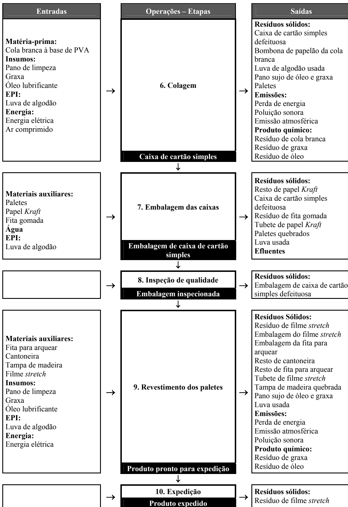
Figura 3.6 (c) – Fluxograma intermediário da fabricação de embalagens de papel cartonado simples
