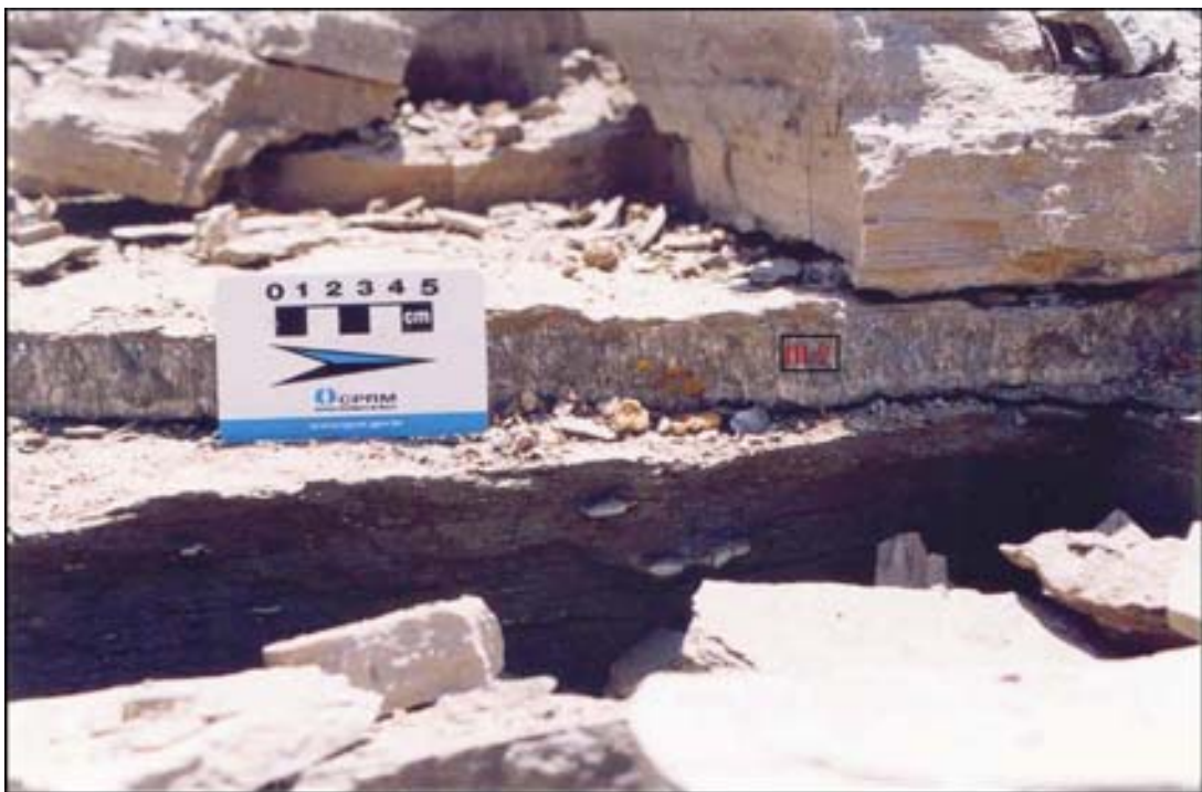
Foto III.8 – Nível de calcita fibrosa com estrutura beef ou cone-in-cone , na base da unidade carbonática C6. Este nível é identificado em toda a área do afloramento. O retângulo indica a posição da foto III.9.
