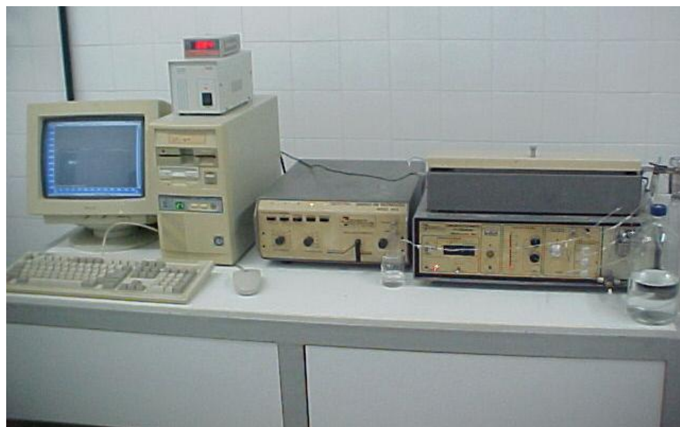
FIGURA 9 – Cromatógrafo CG-480 utilizado das análises de açúcares e lactitol.
