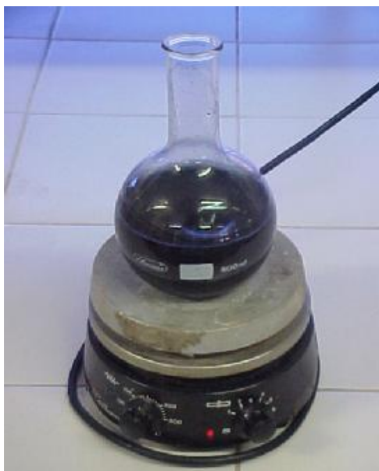
FIGURA 7 – Adsorção das proteínas do soro pós tratamento térmico utilizando carvão ativado.
