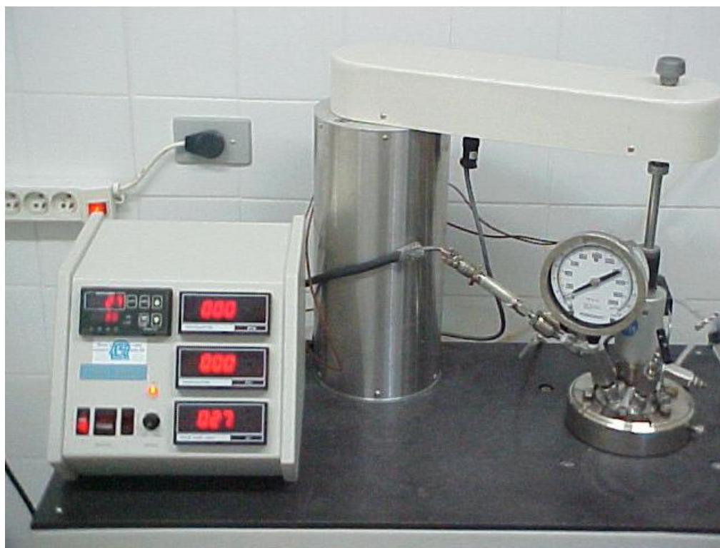
FIGURA 8B – Reator trifásico PARR 3543 utilizado na hidrogenação da lactose
