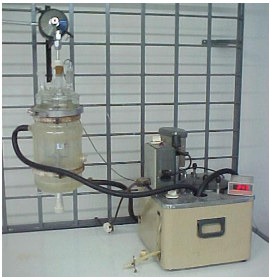
FIGURA 5 – Reator de vidro encamisado, agitador mecânico e equipamento de banho termostático utilizados no tratamento térmico do soro de queijo bruto.
