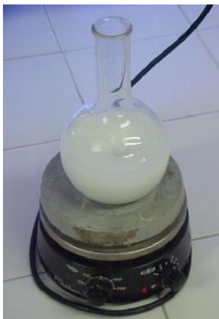
FIGURA 6 – Adsorção das proteínas do soro pós tratamento térmico utilizando hidroxiapatita como adsorvente.
