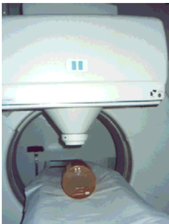
Figura 7 - Simulação da captação tireoideana com o fantoma na câmara a cintilação
