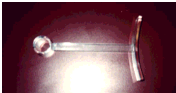
Figura 13 - O suporte de acrílico utilizado na pesquisa para fixar a sonda a cintilação a uma distância de 10 cm da face anterior do pescoço dos pacientes.
