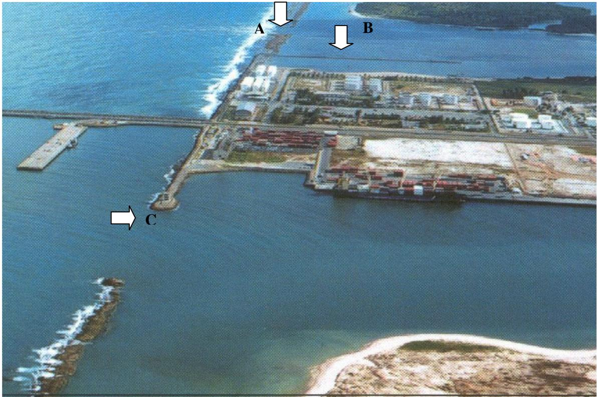
Figura 02: Vista aérea do Porto de Suape, mostrando em A: ruptura parcial de recife permitindo a comunicação do Rio Ipojuca com o mar ; B: aterro que bloqueou a comunicação dos Rios Ipojuca e Merepe com a Baía de Suape; C: Abertura de Canal de comunicação do mar com a Baía de Suape, onde foi contruído o porto interno. (Fonte: Suape Complexo Industrial Portuário, 2002).
