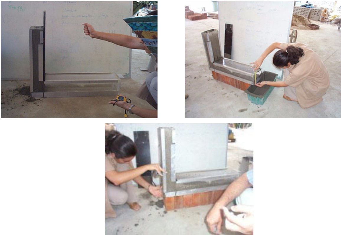
Figura 2.15 – Ensaio da Caixa em L.
