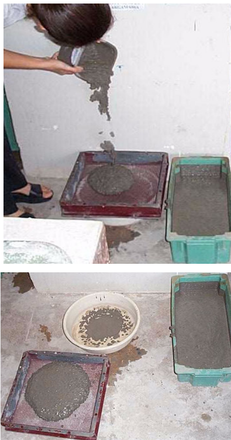
Figura 2.17 Ensaio GTM para avaliação da segregação.
