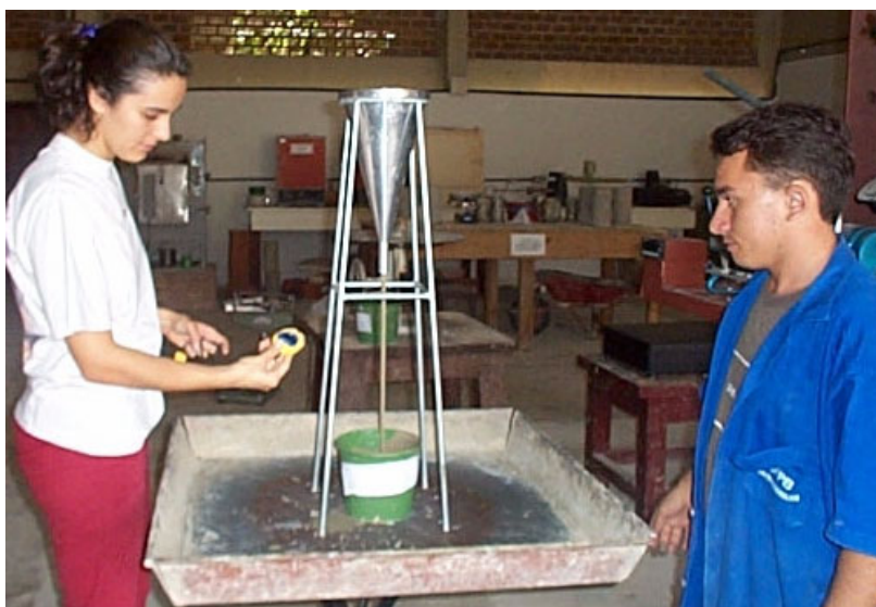
Figura 2.3 - Execução do ensaio com o Funil de Marsh.
