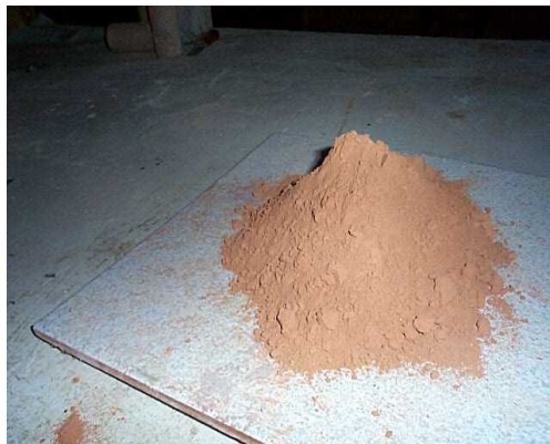
Figura 3.1 – Pozolana obtida de resíduos de blocos cerâmicos
