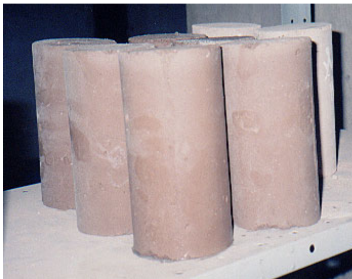
Figura 5.11 – Aspecto do concreto endurecido com pozolana
