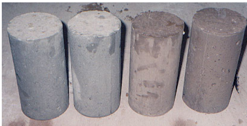
Figura 5.12 – Diferença de coloração entre o concreto com pó calcário e com pozolana
