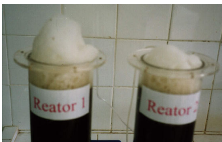
Figura 7.12- Detalhe da formação de espuma durante o período de início de operação dos reatores do teste de biodegradabilidade aeróbia biótico do chorume do Aterro da Muribeca.
