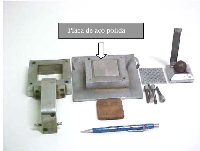
Figura 4.9. Peças utilizadas no ensaio de cisalhamento direto com interface lisa.
