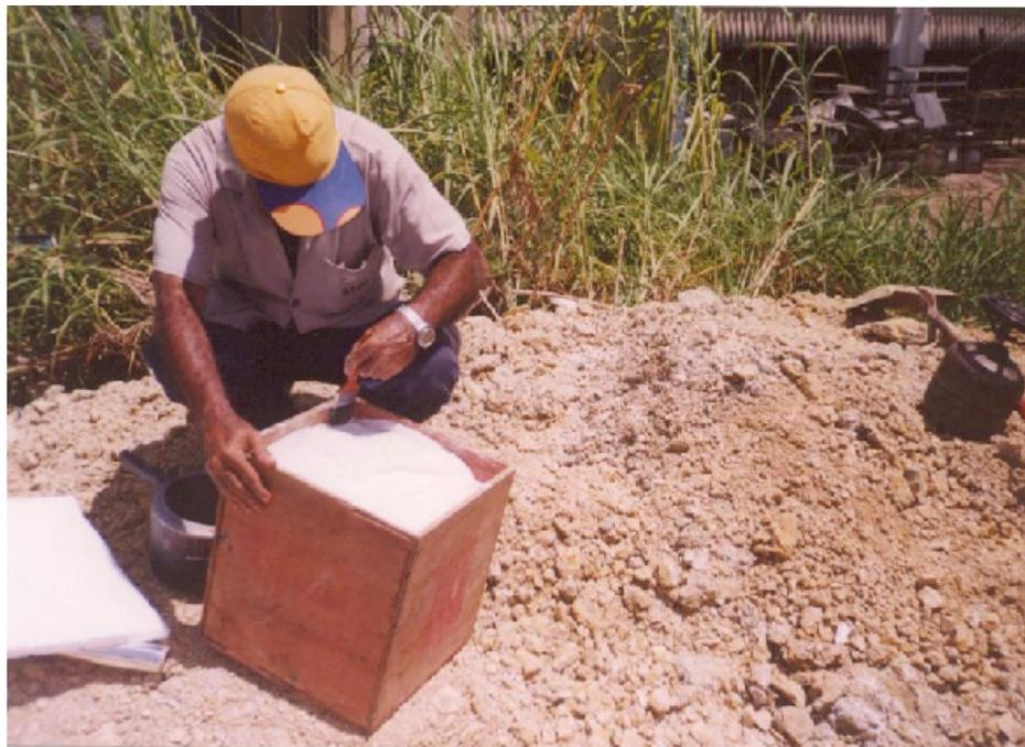
Figura 3.16. Acondicionamento do bloco.
