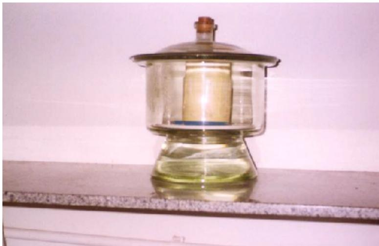
Figura 4.4. Acondicionamento dos corpos de prova.
