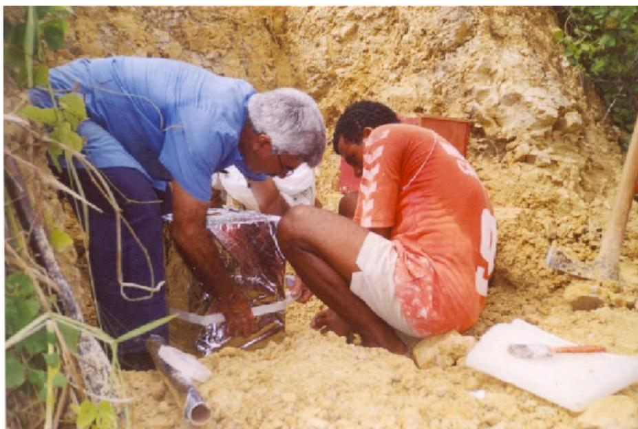
Figura 3.14. Preparação do bloco para parafinação.
