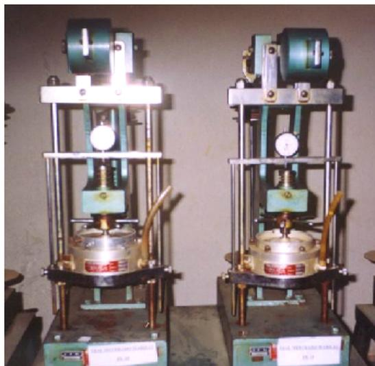
Figura 4.5. Prensas de adensamento.
