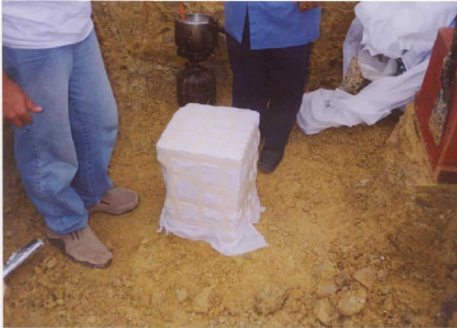
Figura 3.15. Preparação do bloco para parafinação.
