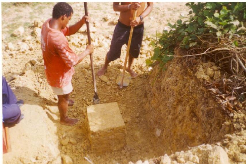
Figura 3.13. Moldagem do bloco.
