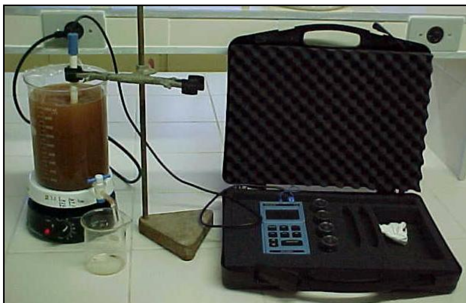
FIGURA 09 – Sistema Utilizado para Realização dos Testes Cinéticos.
