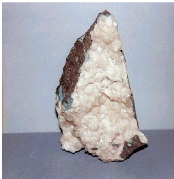
FIGURA 05 – Amostra de Zeólita Estilbita (SIQUEIRA, 2001).
