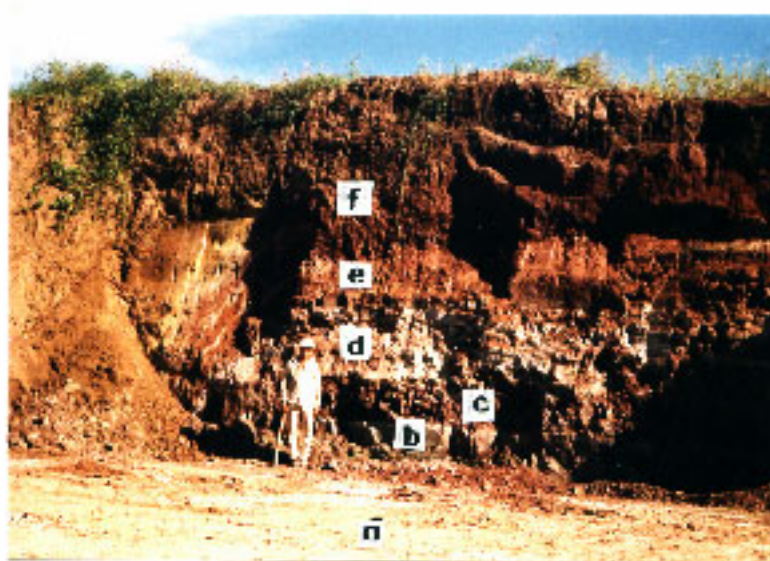
Fig. 3.5 – Frente de lavra da mina Rancharia II – Araripina-PE, mostrando: a) gipsita Membro Ipubi); b) argilito; c) argilito; d) arenito; e) marga; f) solo (Membro Romualdo).
