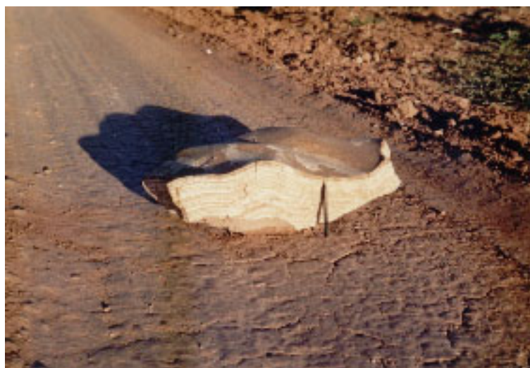
Fig. 6.12 – Aspecto da gipsita ondulada, visto em uma amostra do perfil da mina Campevi – Araripina-PE.
