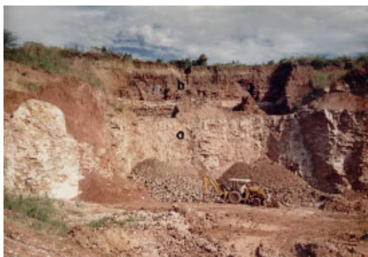
Fig. 3.3 – Vista panorâmica da frente de lavra da mina Gipso - Araripina-PE, mostrando: a) gipsita (Membro Ipubi); b) argilas esmectíticas (Membro Romualdo)
