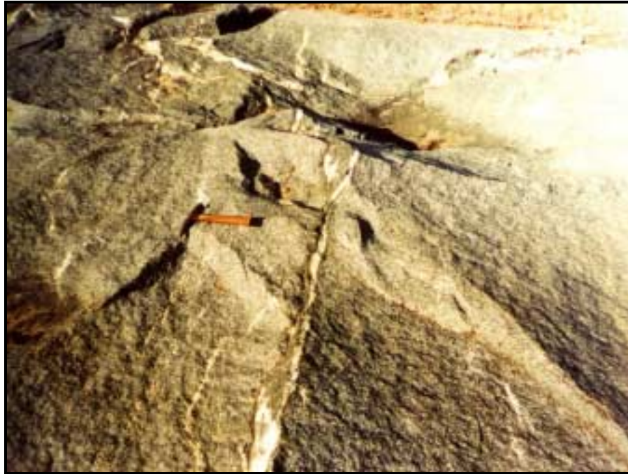
Fotografia 15: Metagranodiorito aflorando sob a forma de maciço rochoso, muito fraturado, indicado para a produção de ladrilhos para calçamento e brita, mas não para extração de blocos (afloramento 32, nordeste do Sítio Lagoa da Pedra).
