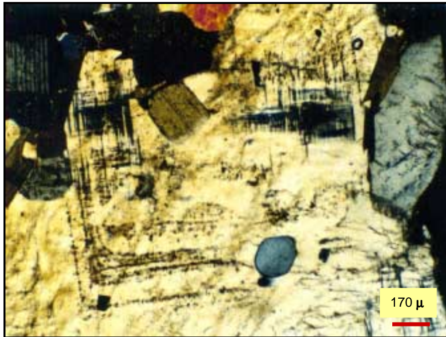
Fotografia 27: Fotomicrografia de K-feldspato mostrando linhas de crescimento, contendo inclusões de biotita e quartzo, (amostra CH-GC-32).
