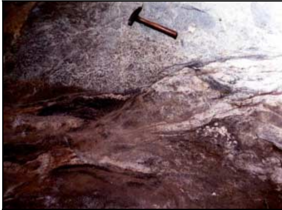
Fotografia 53: Diatexito mostrando porções com textura nebulítica (afloramento 17, localizado ao norte do Sítio Volta do Rio). Aprecia-se o leucossoma leucogranítico com uma faixa (restito) de melanossoma orientado segundo a direção do fraturamento 140^\circ Az. Na porção superior observa-se o mesossoma (ortognaisse cinza) mais homogêneo de composição granodiorítica. Na parte central observa-se zonas de cisalhamentos (sinistrais).
