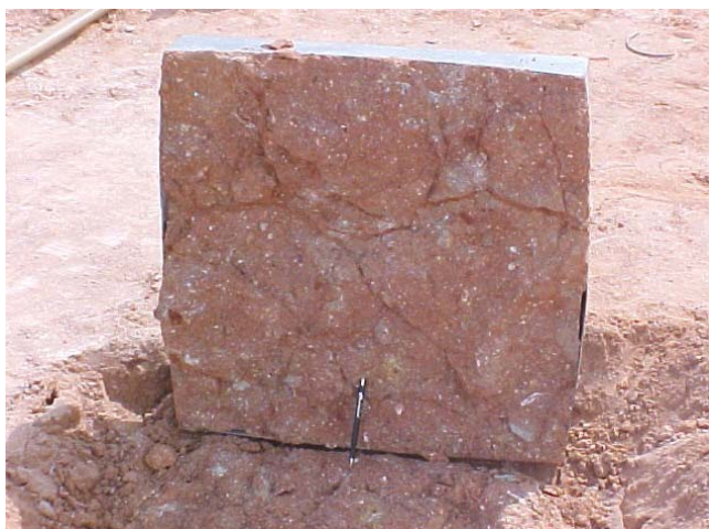
Figura IV.13. Placa retirada da camada após execução do ensaio.
