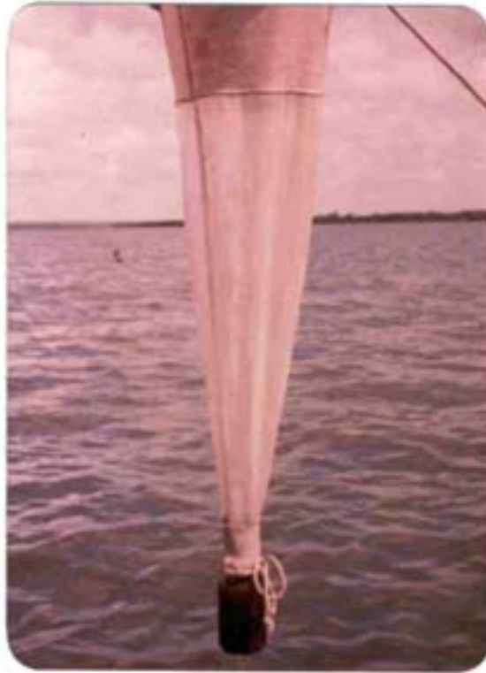
Fig. 23 - Rede para coleta de plâncton. Note-se a coloração escura do vidro no final da rede onde ficou retido o plâncton em um arrasto de cinco minutos.
