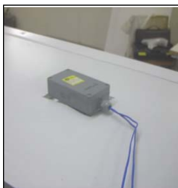
Figura 5.37(a e b) – Medidor de umidade e temperatura de ar interno do túnel.
