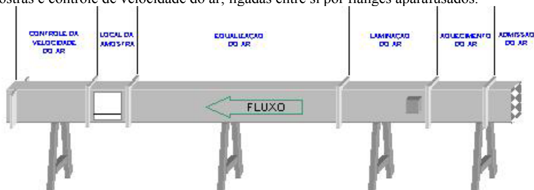
Figura 5.2 - Vista do túnel e a representação da divisão dos módulos.
