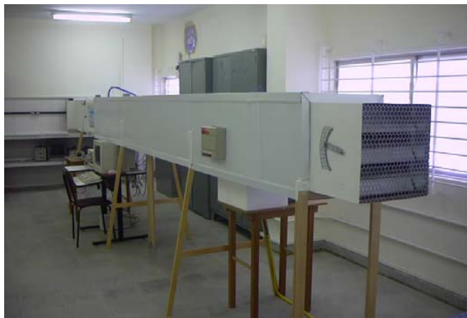
Figura 5.3 - Vista frontal e posterior do túnel de vento, e detalhe do Módulo de admissão de ar.
