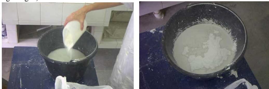
Figuras 4.6(a e b) – Detalhe da preparação da mistura gesso-água
