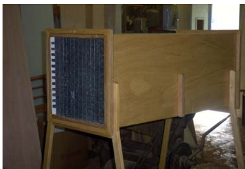
Figura 5.5 – Detalhes do Módulo laminador do fluxo de ar
