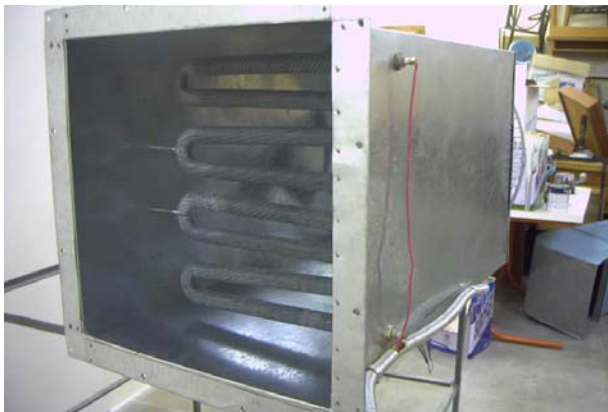
Figura 5.4 – Detalhes do Módulo de aquecimento do ar
