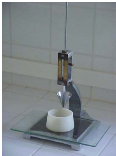
Figura 4.3 – Detalhe do aparelho Vicat modificado.
