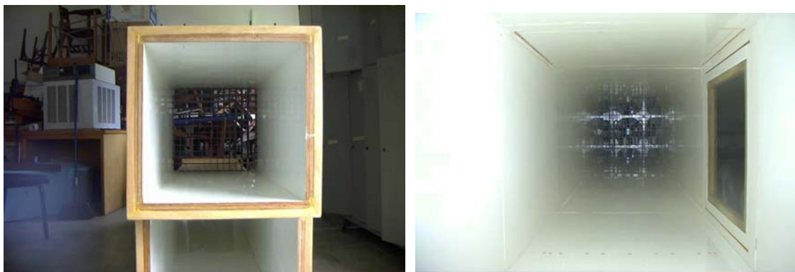
Figura 5.12(a e b) – Detalhes do revestimento interno do túnel de vento, da janela da seção de testes, e do laminador do fluxo de ar, ao fundo.
