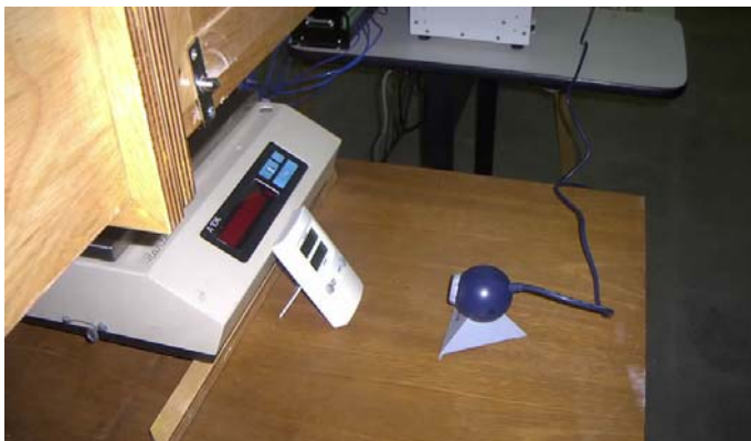
Figura 5.39 – Posicionamento do higrotermógrafo e a webcam.
