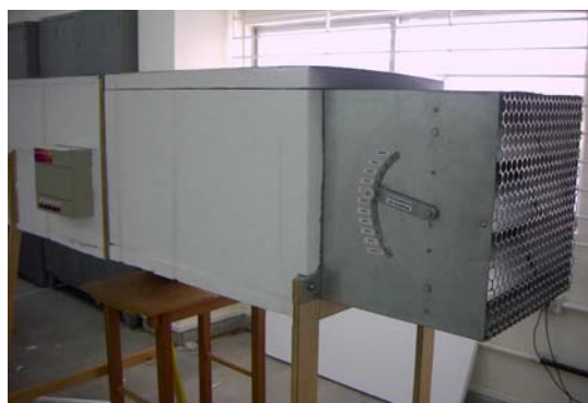
Figura 5.23 – Detalhe o isolamento e acabamento do túnel.
