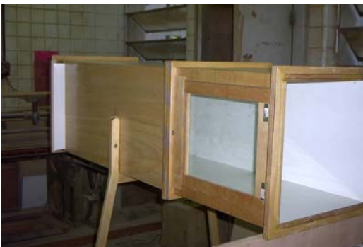
Figura 5.11 – Detalhe da construção do corpo do túnel, módulo das amostras.
