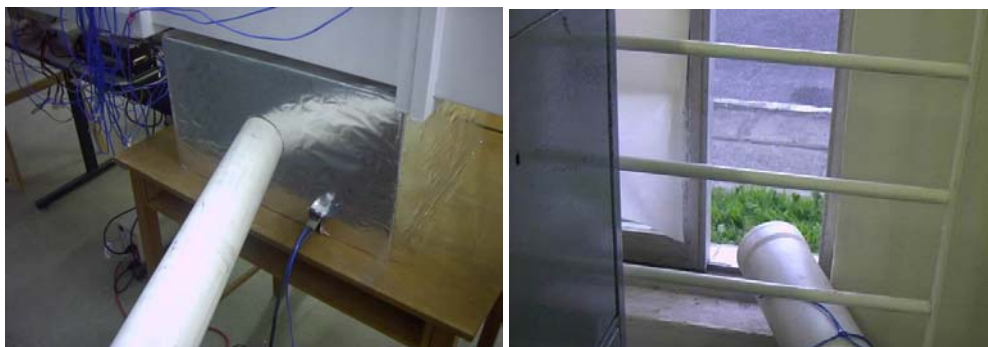
Figura 5.43(a e b) – Detalhes do captador de ar para a balança.
