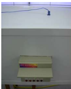
Figura 5.31 – Termopar para registro da temperatura do ar logo após as resistências.
