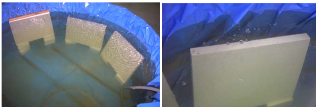
Figura 7.1 (a e b) – Placas de gesso sendo hidratadas antes do ensaio.
