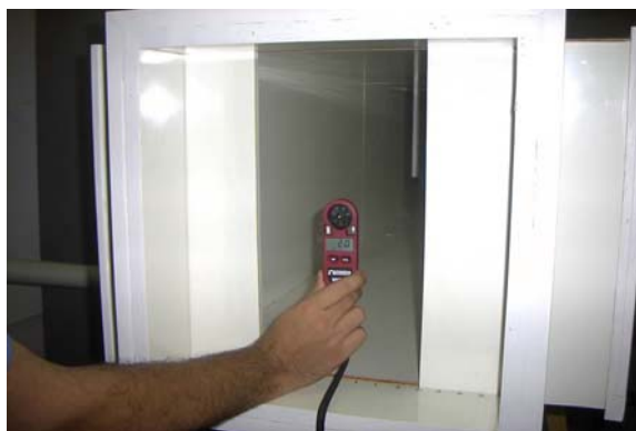
Figura 5.44 – Detalhe do anemômetro e medição de velocidade do ar.
