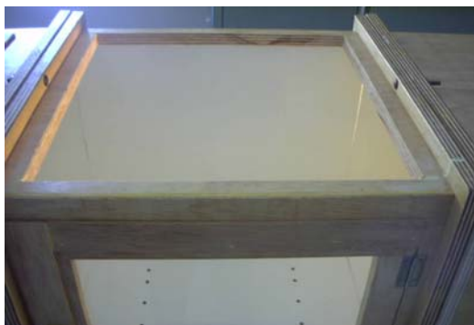
Figura 5.13 – Detalhe da fixação dos flanges
