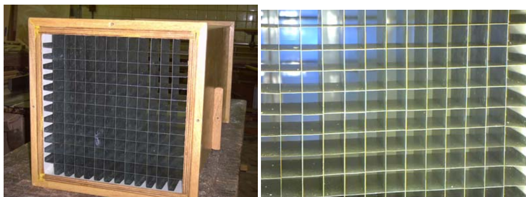
Figura 5.21(a e b) – Detalhe do laminador do fluxo de ar
