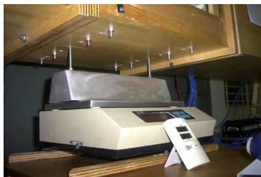
Figura 5.29(a e b) – Sistema de fixação da placa monitorada.
