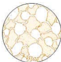
Figura 3.6 –Desenho de corpo poroso, onde se vê a estrutura dos poros e capilares.
