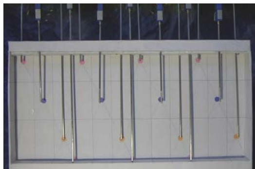
Figura 5.33–Esquema proposto para a distribuição dos termopares no interior da placa.
