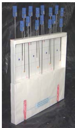
Figura 5.32 – Detalhes da fixação dos termopares na placa
