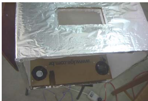
Figura 5.42 – Detalhe do Isolamento da balança
