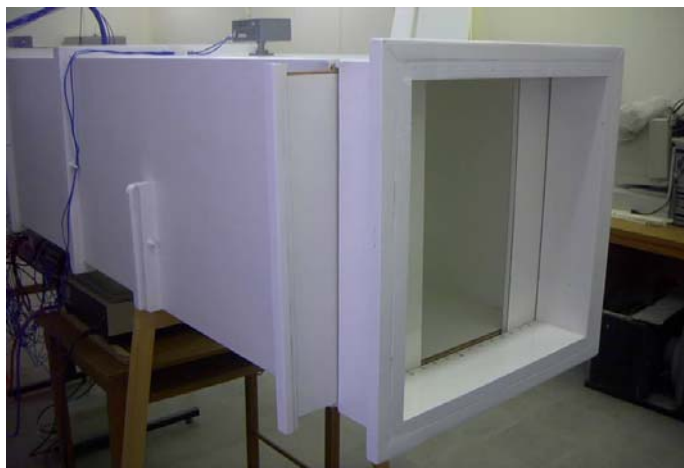
Figura 5.8 – Detalhes das comportas de controle de vazão, com a da escala de medição da velocidade de ar.
