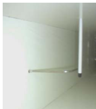
Figura 5.37(a e b) – Medidor de umidade e temperatura de ar interno do túnel.
