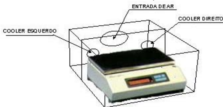
Figura 5.41 – Esquema do isolamento da balança
