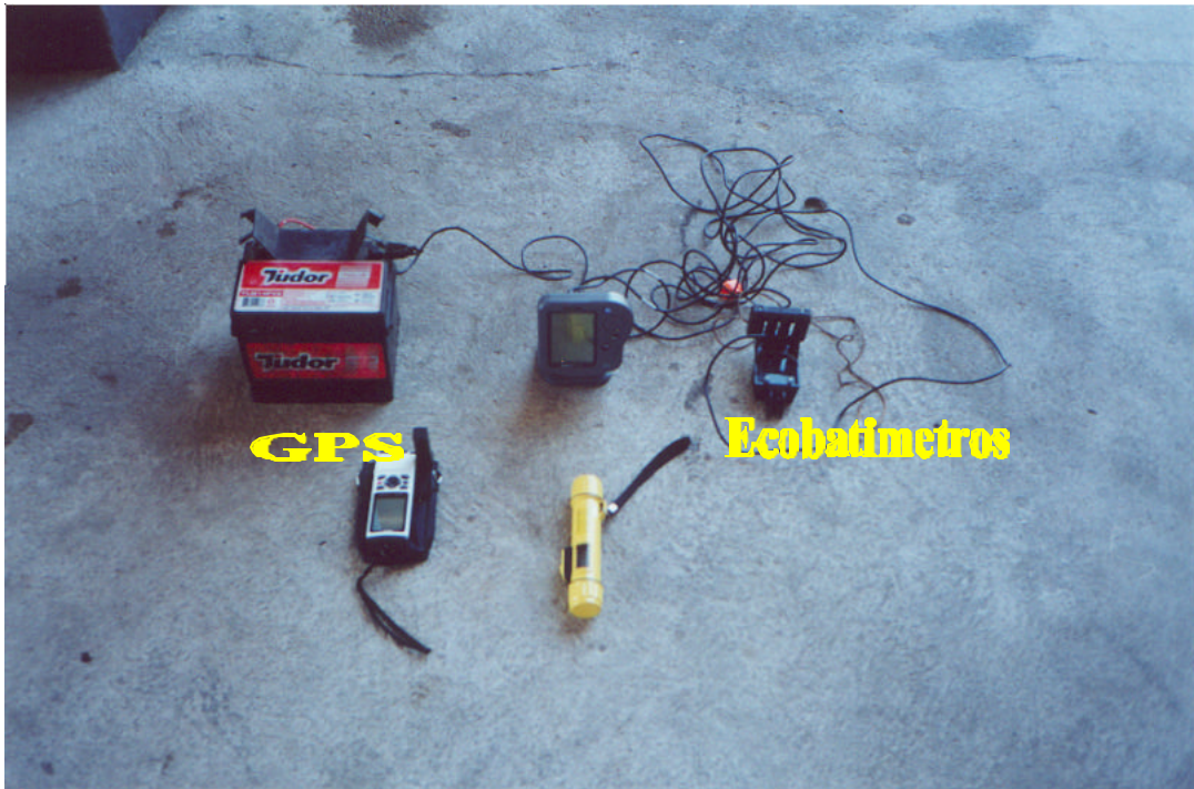
Foto 3 – Equipamentos utilizados na coleta dos dados batimétricos.
