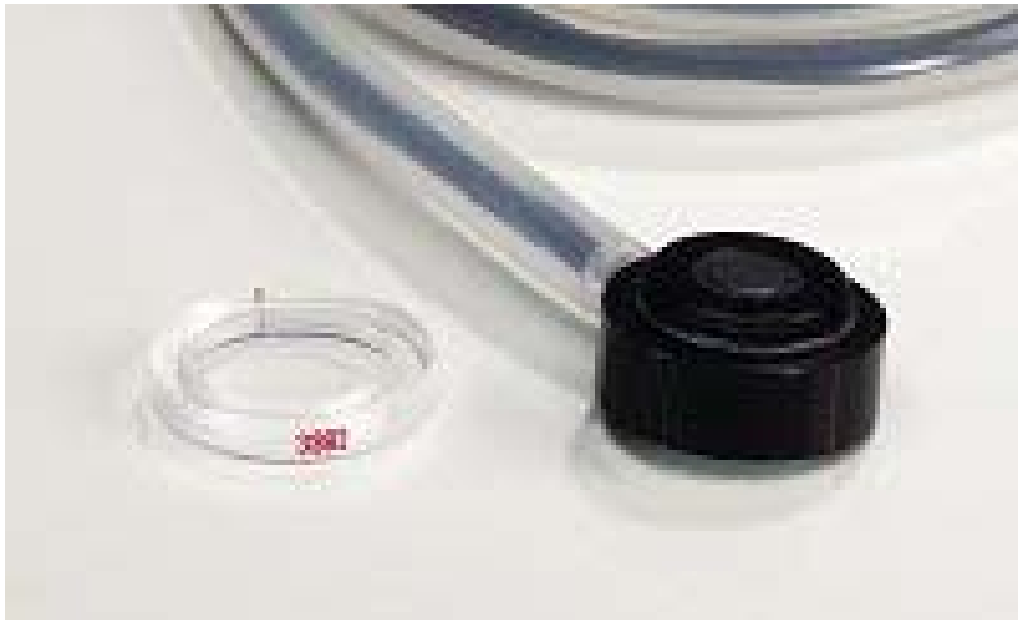
Figura 18. Câmara de ionização de placas paralelas do tipo Markus, modelo 45324
