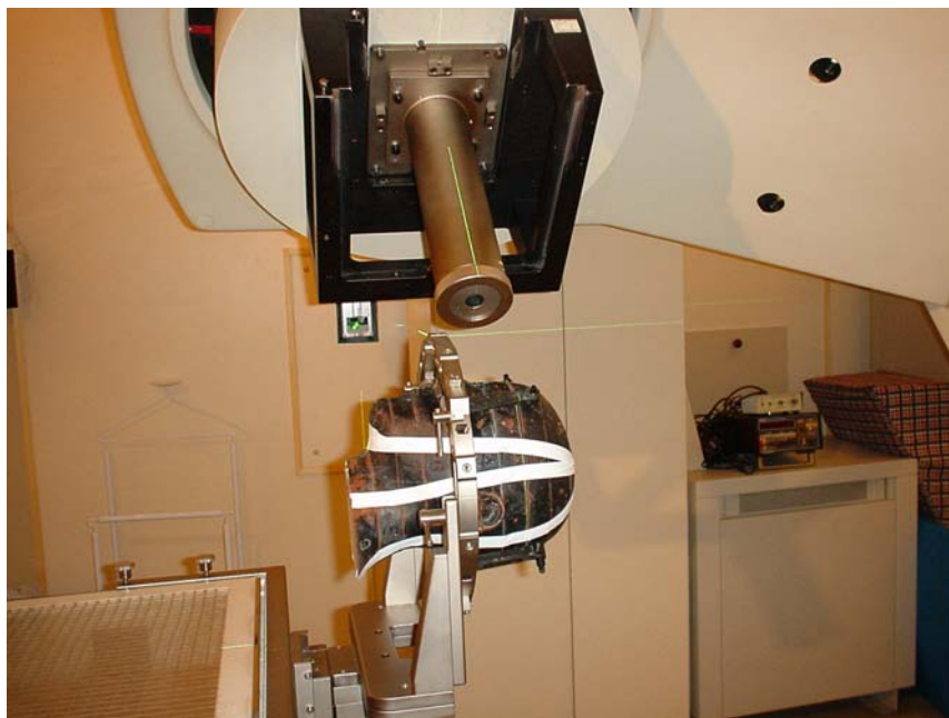
Figura 71. Esquema de irradiação implementado para a verificação da dose do planejamento e da dose do tratamento com quatro arcos.
