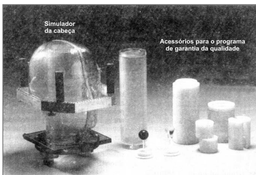
Figura 14. Simuladores e acessórios construídos na Universidade McGill Montreal, Quebec, Canadá, para verificação das técnicas de localização do alvo e das medidas de distribuições das doses em radiocirurgia 10 .
