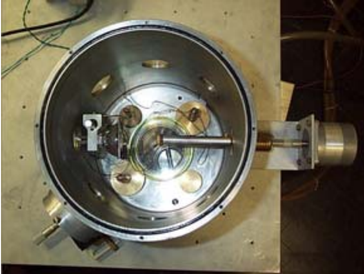
Figura 3.2 Vista superior da câmara de evaporação usada para na obtenção dos filmes de CdS.
