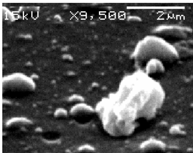
Figura 4.1 Detalhe ampliado de uma micrografia de varredura da amostra S4 onde podemos ver a formação do aglomerado mais claro produzido pela ação mecânica do fluxo de partículas expelidas durante a expansão do plasma. Os componentes altamente energéticos do plasma arrastam partículas sólidas que voam até a superfície em crescimento. A cor mais clara é resultado do menor contato elétrico entre a partícula e a superfície do filme.
