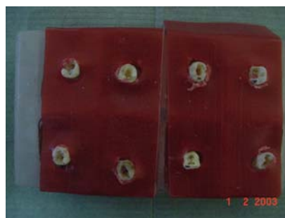
Figura 2- Forma para confecção de bloco de gelo que serviu como molde para padronização dos espécimes.
