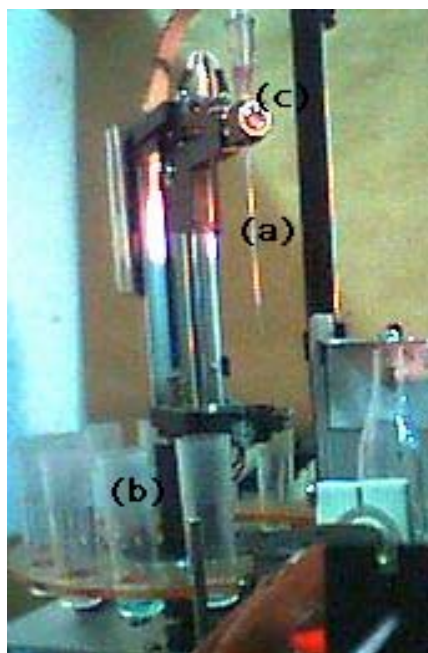
Figura 22 - Amostrador automático: (a) agulha, (b) depósitos e (c) alavanca amostradora.
