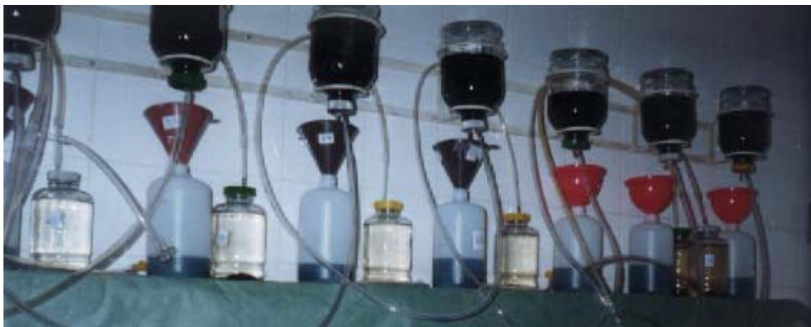
Figura 4.7: Conjunto experimental utilizado para os testes de AME e de biodegradabilidade anaeróbia.
