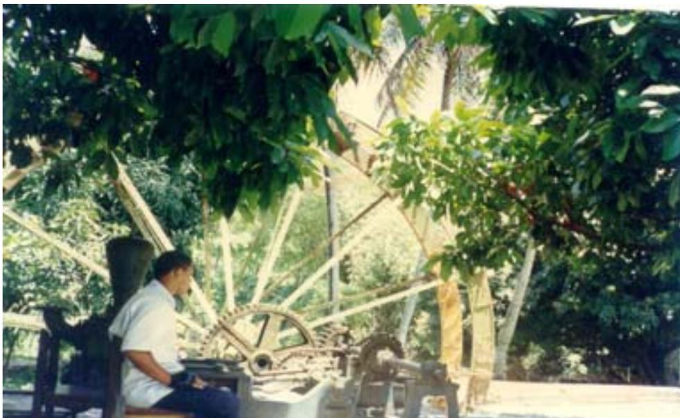
**Figura 6:** Roda D'água e Bomba Inglesa, no rio Beberibe localizada no bairro de Caixa D'água em Olinda, primeiro ponto de captação de água encanada da cidade de Olinda. (Foto do autor, 05/07/1997).
