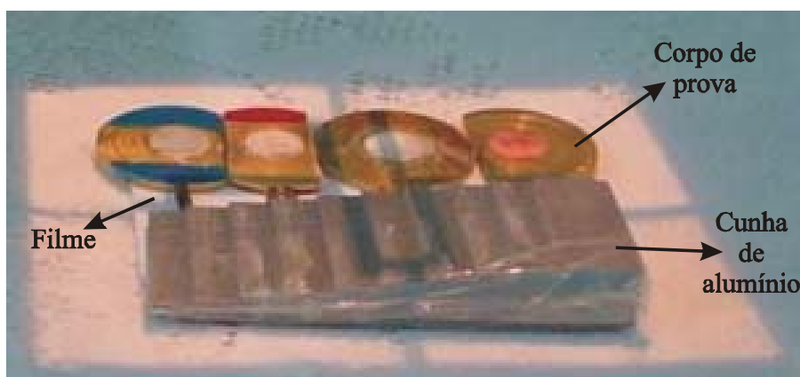
Figura 4.3 – Arranjo experimental mostrando o posicionamento dos corpos de prova e do Penetrometro de alumínio sobre o filme radiográfico
