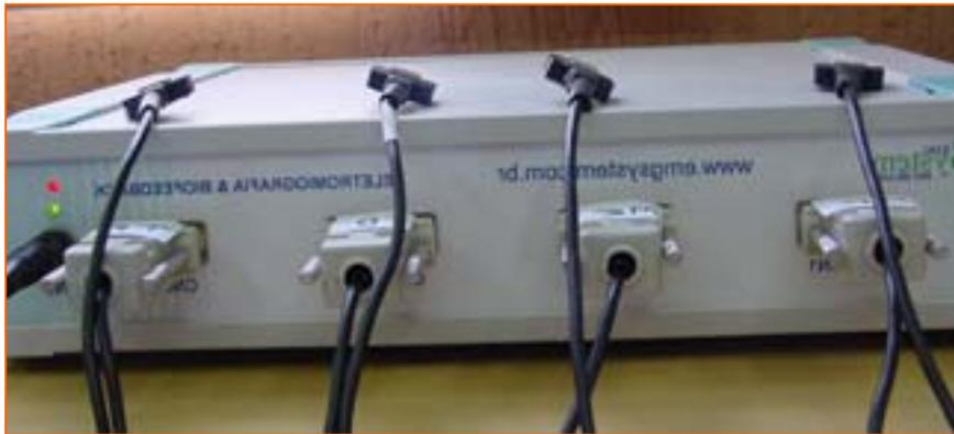
**Figura 19:** Módulo amplificador do eletromiógrafo.
