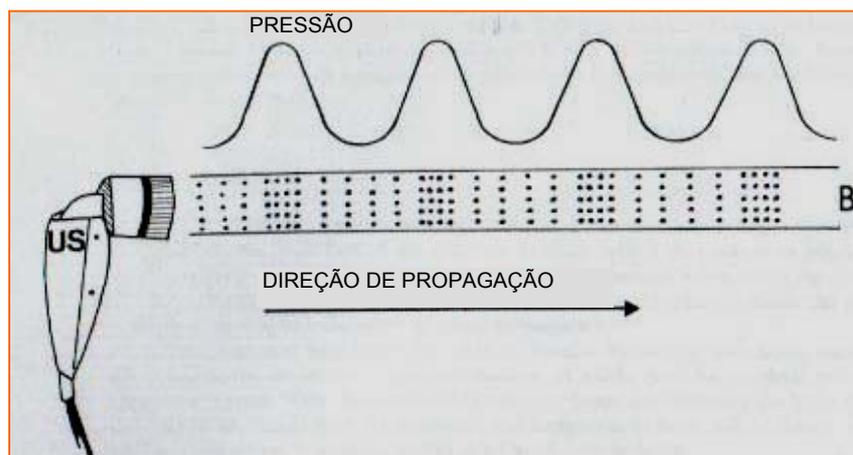
**Figura 7:** Diagrama do feixe de ultra-som com as áreas de compressão e rarefação molecular. (Zinkin, M.C. et al., *Therapeutic Ultrasound. In: Kloth, L.C. (Col.). Thermal Agents in Rehabilitation. e.7, p.134-141.*)
