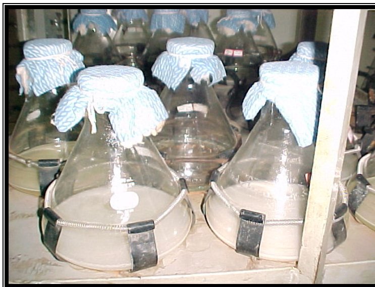
Figura 7 – Experimentos de biodegradação em frascos Fernbach
