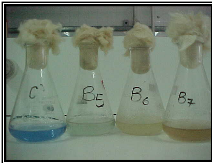
Figura 11 – Viragem do indicador DCPIP pelos isolados B5, B6 e B7 após 15, 67 e 172 horas de cultivo, respectivamente.
