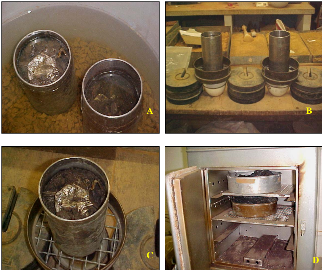
Figura 4.13 – Procedimentos no laboratório (A) Saturação da amostra pelo processo de vasos comunicantes (B) Livre Drenagem da amostra do lixo (C) Ensaio finalizado após a drenagem da “última gota” e imediatamente colocada na estufa para obtenção da umidade na capacidade de campo.
