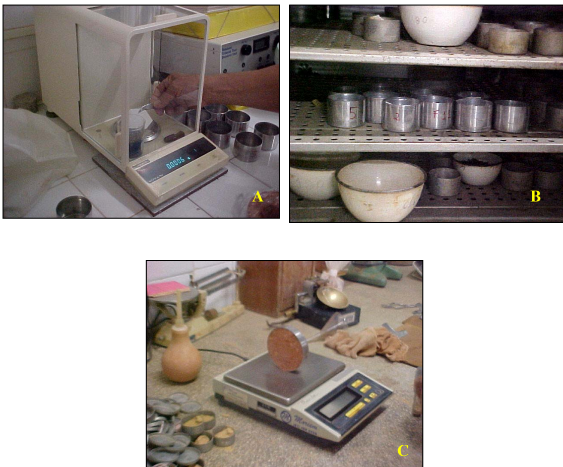
Figura 3.22 – Procedimentos da coleta de dados: (A) Pesagem do papel filtro em uma balança analítica utilizando-se de uma pinça (B) Papel Filtro colocado para secagem em uma estufa a 105°C para obtenção da umidade (C) Pesagem do anel + solo.
