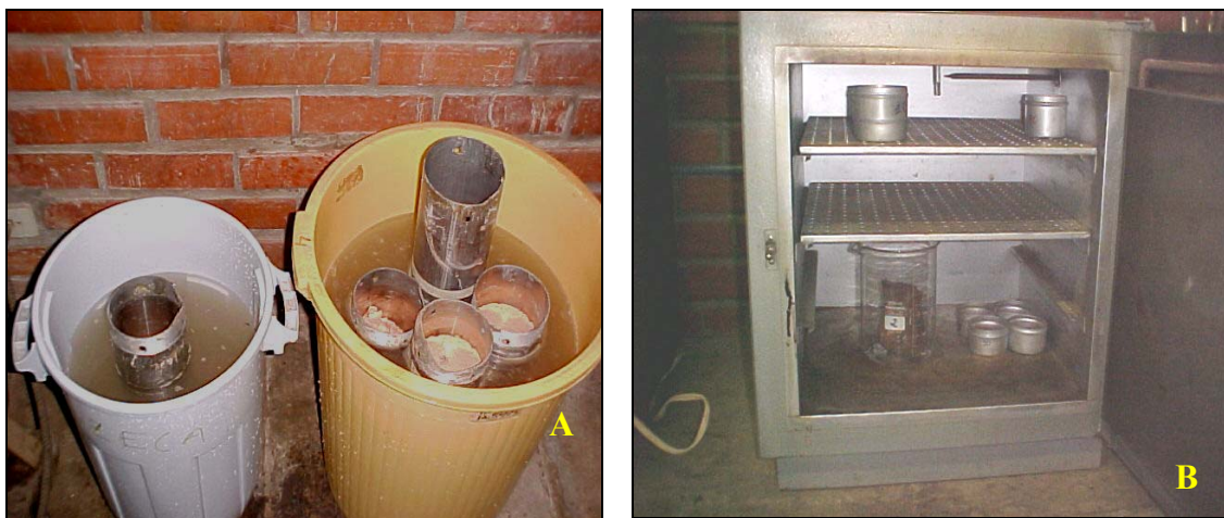
Figura 4.2 – Análises em laboratório. (A) Saturação do solo através do processo de vasos comunicantes. (B) Depois de totalmente drenada, a amostra é colocada na estufa.
