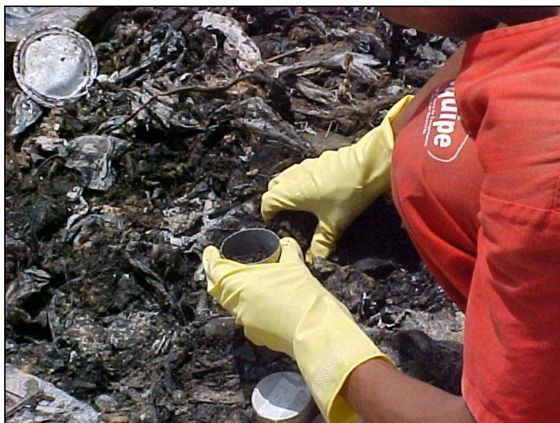
Figura 3.12 – Obtenção da amostra de lixo para determinação de umidade.
