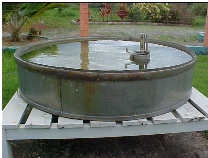
Figura 3.4 – Evaporímetro utilizado no Aterro da Muribeca.
