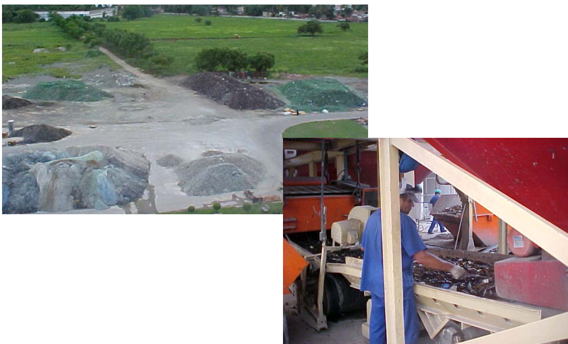
Figura 5.27a: Acomodação do Caco de Vidro no Pátio da Indústria e Processo de Quebra Manual e Separação Por Cor
