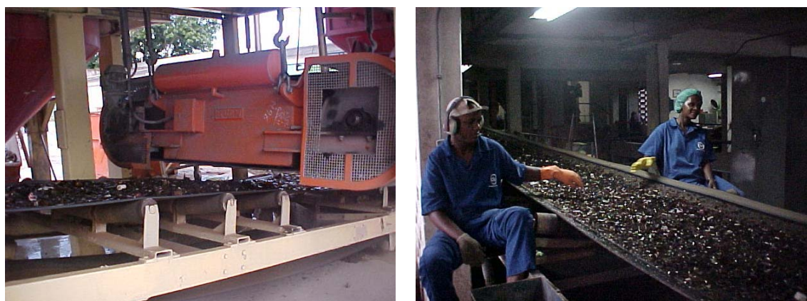
Figura 5.27b: Caco de Vidro Passa por um Imã para Eliminação dos Contaminantes, após Passar pelo Imã é Feita Nova Separação Manual para Garantia De Eliminação Dos Mesmos.
