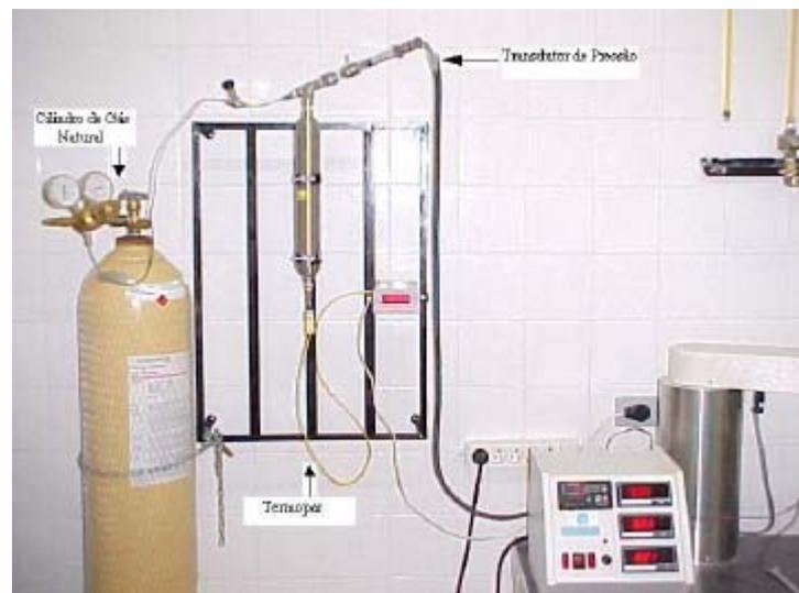
**FIGURA 3-1.** Sistema adsortivo gás-sólido em batelada.
