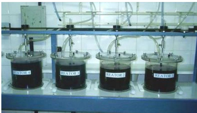
**Figura 3.15** - Equipamento utilizado para o teste de biodegradabilidade anaeróbia (BIO 2).
