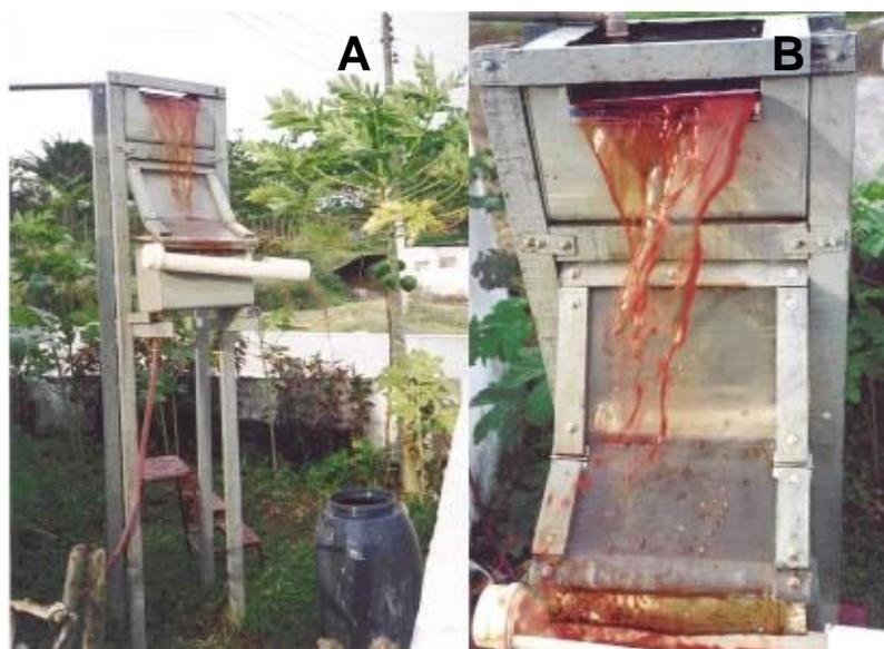
**Figura 3.9** - Peneira estática para remoção de sólidos suspensos do afluente do reator UASB (A), e detalhe da peneira em operação (B).
