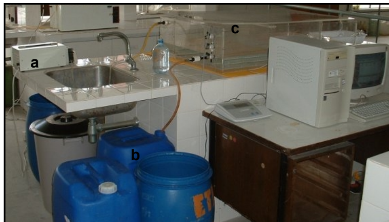
Figura 10 – Unidade piloto composta de: (a) bomba peristáltica, (b) tanques de alimentação em polietileno, (c) reator contínuo tipo tanque (canal) em acrílico.
