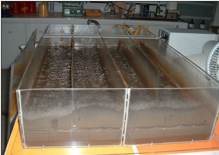
Figura 15 – Reator canal funcionando como tanque de aeração.
