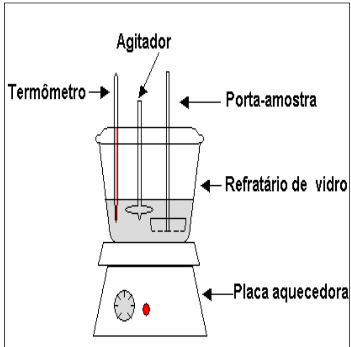
Figura 3.6: Aparato experimental para a fabricação de guias de ondas pelo método do refratário.
