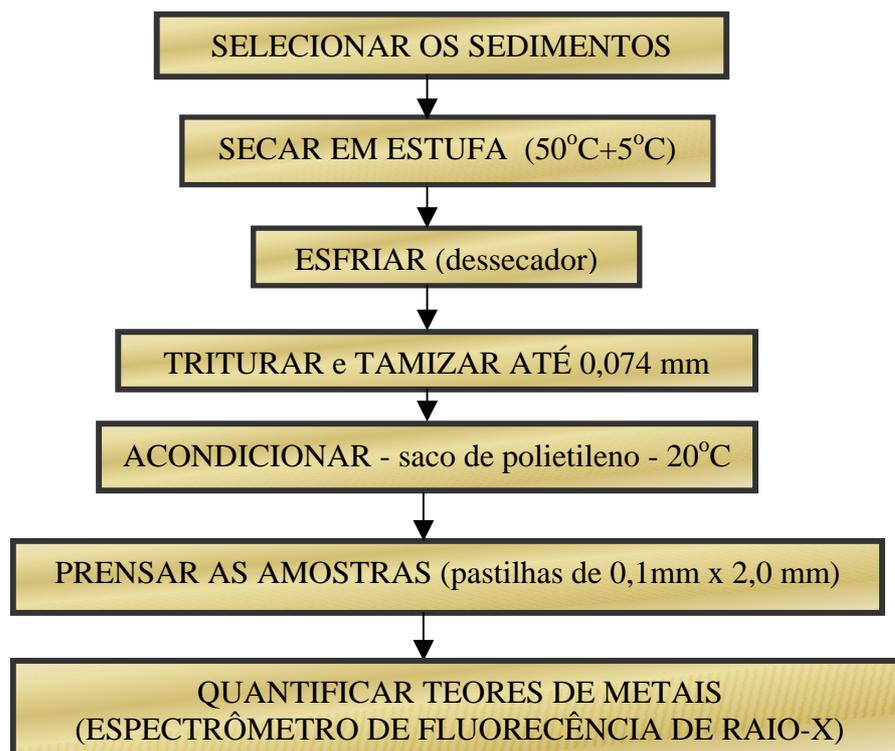
Figura 04: Fluxograma para determinação dos metais em sedimentos
