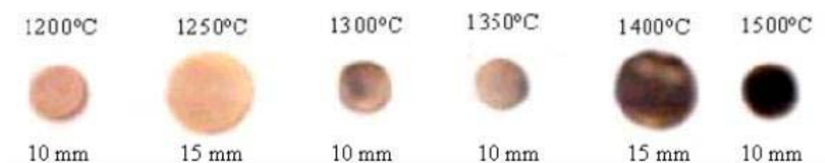
Figura 4.1: Pastilhas do sistema cerâmico \text{Ba}_2\text{MgWO}_6 (preparadas com \text{BaO} ) sinterizadas nas temperaturas indicadas. A imagem não está em tamanho real.
