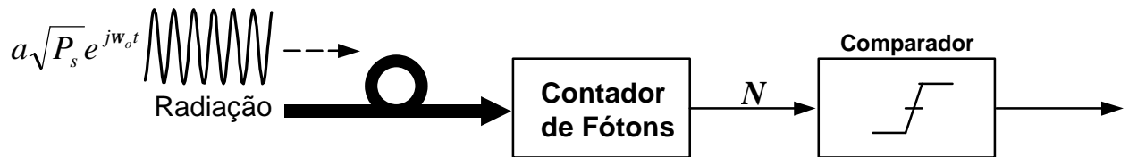
Figura 4.4 – Representação do receptor de um sistema de comunicação óptica. O parâmetro “a” modula a intensidade da radiação emitida. Se um bit ZERO for emitido então “a” é nulo e se um bit UM for emitido “a” é não nulo.
